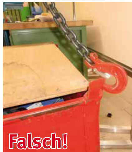
Bild 16-4: Haken rutschen bei Schlaffketten aus den Ösen
