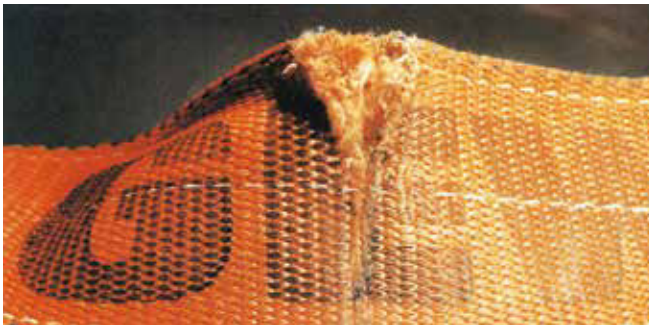
Bild 23-14: Durch scharfkantige Last eingeschnittenes Hebheband
