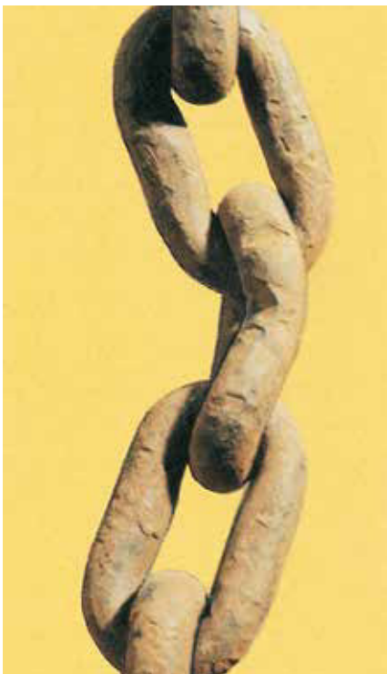
Bild 23-10: Kette mit verbogenem und eingekerbtem Kettenglied
