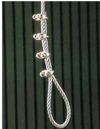
Bild 9-4: Fertig zum Einsatz! Alle Klemmbögen sitzen auf dem tragenden Strang
