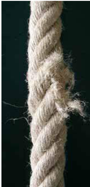
Bild 23-7: Zerstörung einer Litze
