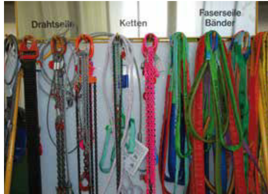
Bild 24-1: Vorbildliche Aufbewahrung von Seilen und Ketten
