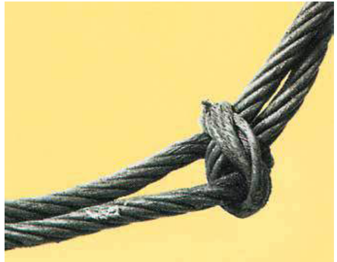
Bild 9-2: Unzulässiger Knoten zerstört den Seilverbund
