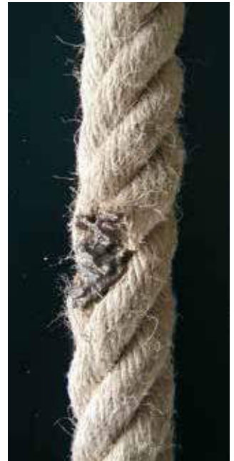
Bild 23-9: Wärmeeinfluss hat eine Litze zerstört
