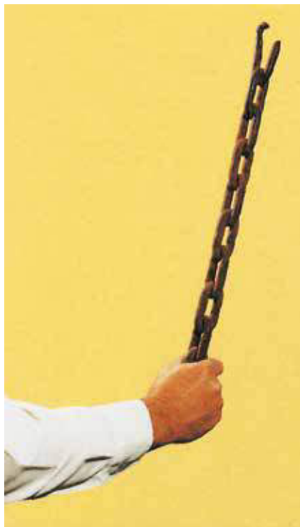
Bild 23-11: Durch Überlastung steif gezogene Kette
