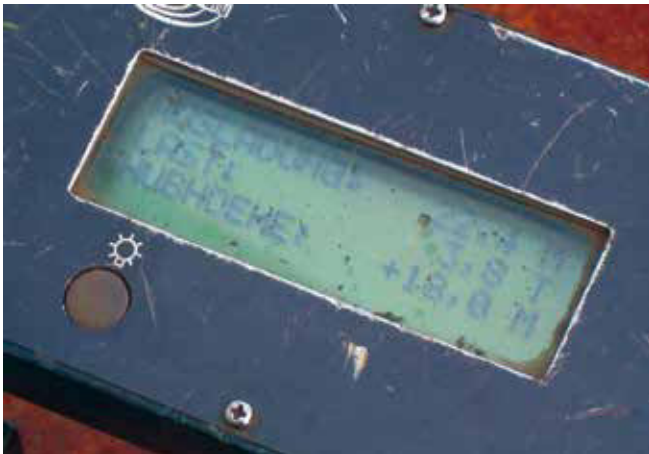
Bild 5-3: Steuerbirne mit digitaler Lastanzeige
