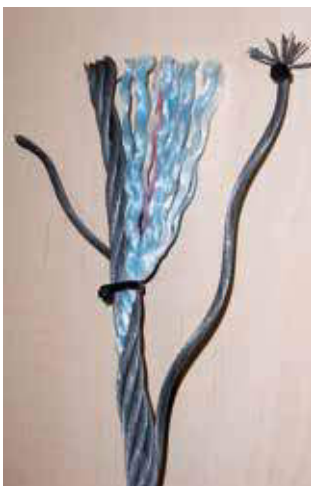
Bild 8-2: Aufbau eines Litzenseiles
