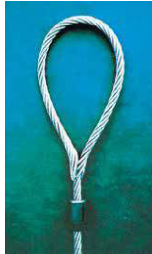
Bild 9-7: Die beiden Enden sind gegeneinander verseilt
