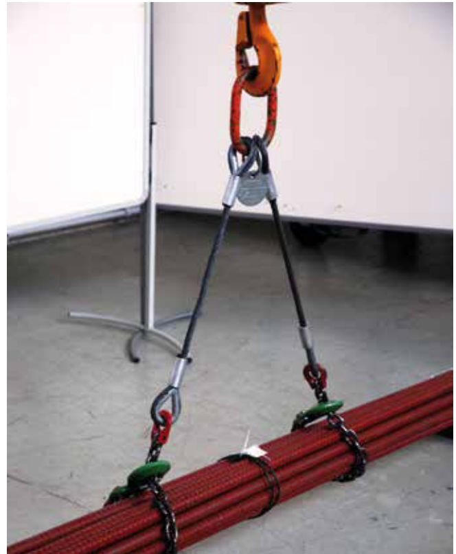
Bild 6-1: Kombination Seil/Kette zur Schonung der Drahtseile
