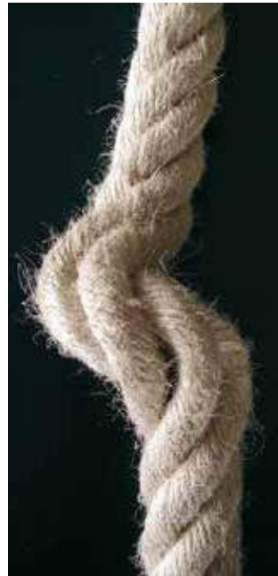
Bild 23-8: Durch Klanke zerstörter Litzenverbund
