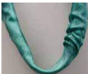
Bild 23-17: Verformung durch Wärme
