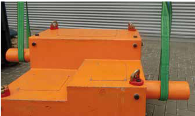
Bild 6-2: Hebebänder sind oberflächenschonend
