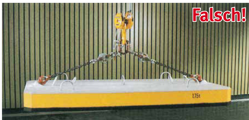
Bild 14-2: Demonstrationslast mit Messelementen im Haken mit bis zu vier Kettensträngen. Bei diesem unzulässig hohen Neigungswinkel übersteigt die Kraft in jedem Einzelstrang das Gewicht der Last!
