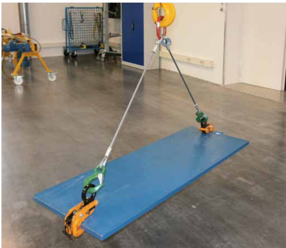
Bild 13-1: Blech horizontal sicher transportiert
