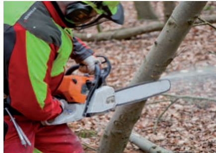
Aus sicherem, seitlichem Stand mit körpernah in Hüfthöhe abgestützter Motorsäge wechselseitig Dach-/Sohlen Schnitte anlegen
