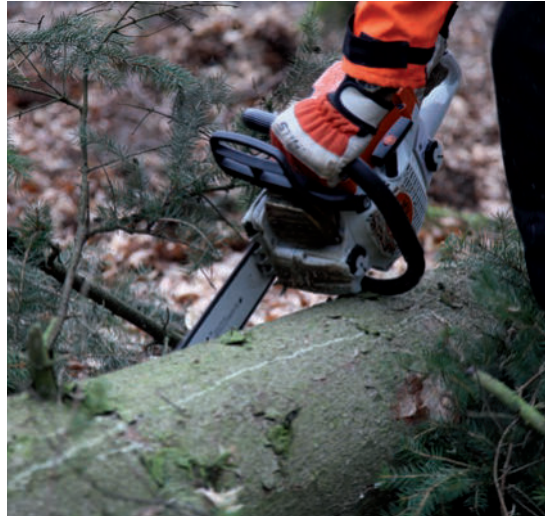
Abstützen der Motorsäge am Stamm bei der Hebelmethode
