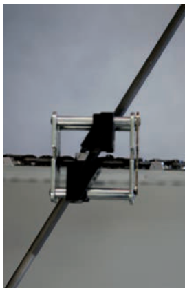
Feilhilfen, wie ein Rollenfeilgerät, ermöglichen eine exaktere Feilenführung.
