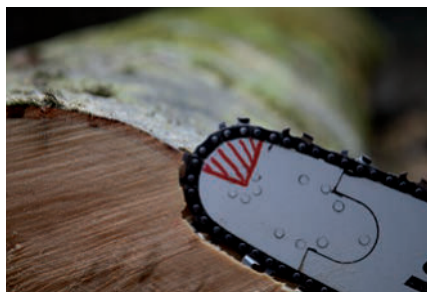
Mit der Schienenunterseite Führungsnut ausformen
