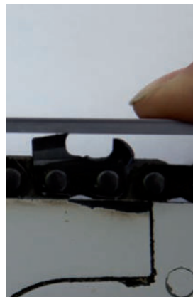
Höhe des Tiefenbegrenzers im Mittel 0,65 mm beachten!
