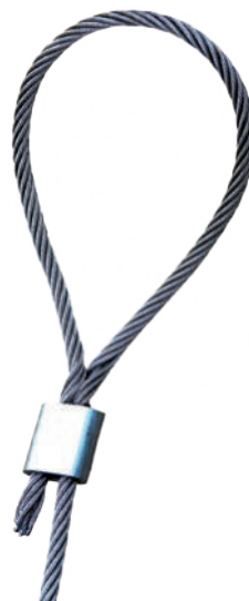
Beilegen der Enden – hier zu einem Seilverband. Vor dem Verpressen der Seilklemme müssen die überstehenden Enden gekürzt werden (1/2 des Seildurchmessers).
