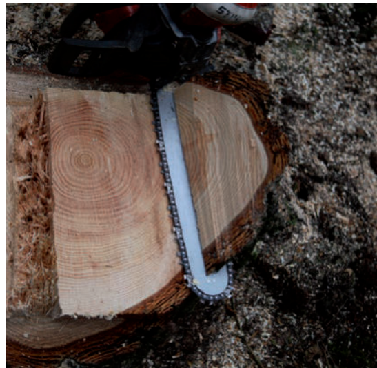
Nach der Fällung Halteband abschneiden
