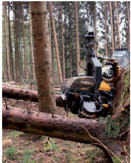
Sichere Spannungs-beseitigung und Abstocken bei der vollmechanisierten Windwurfaufarbeitung
