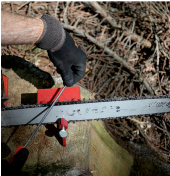
Nachschärfen während der Arbeit. In der Regel reichen ein bis zwei Feilstriche. Feilbock und Schärfgitter helfen dabei.
