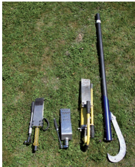
Leichter Wendehaken und „technische Fällkeile“ zur Ergonomieverbesserung bei der Waldarbeit
