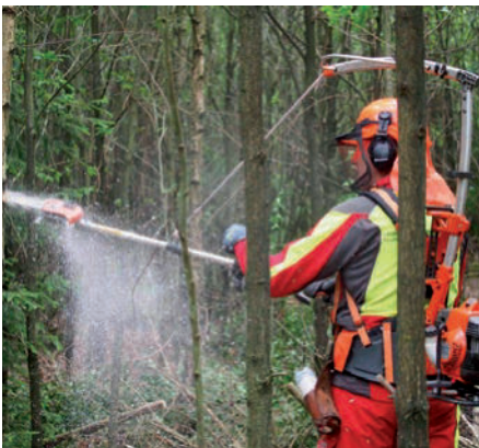
Der sogenannte Spacer ist ein rückentragbarer, ergonomisch bedienbarer Forstfreischneider mit Schneidgarnitur. Die Schneidgarnitur ist an einer Galgenkonstruktion zur Gewichtsentslastung befestigt. Eine Bedienung mit geringster Tragebelastung ist damit möglich, was der ergonomischen und sicheren Steuerung des Arbeitsmittels zugutekommt.
