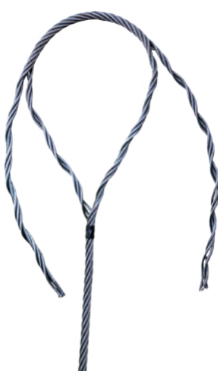
Schleife durch Ineinanderfügen der beiden Litzenverbände bilden.
