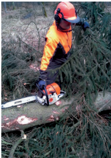
Wegräumen von Ästen mit der Gashand am Griffrohr ist ergonomisch und sicher
