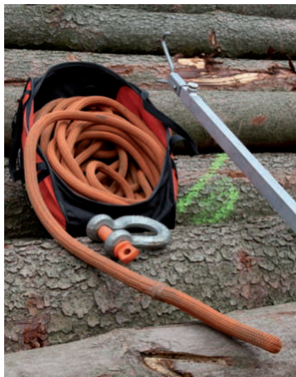
Arbeitsmittel für Anschlaghöhen bis 6 Meter: Teleskopgestänge mit Anschlagkralle, Baumzugseil (hier ummanteltes Kunststoffseil) mit Transportsack und Schäkel
