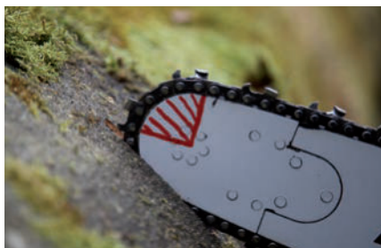
Mit der Unterseite der Schienenspitze ansetzen
