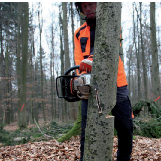
Durchtrennen des Sicherheitsbandes beim diagonalen Stechschnitt
