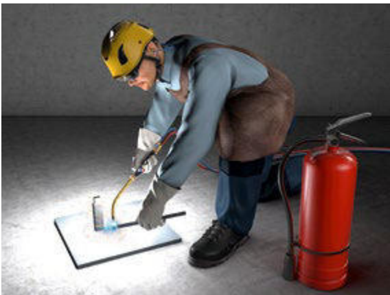
Abb. 67 Schutzausrüstung beim Gasschweißen
