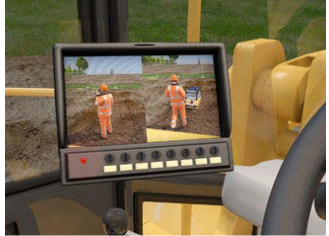
Abb. 74 Splitscreen-Monitor für Rückraum- und Seitenkamera
