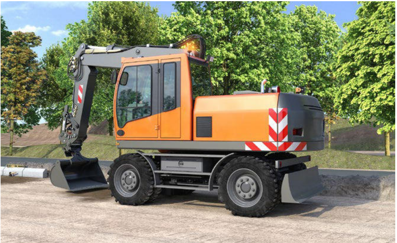
Abb. 68 Sicherheitskennzeichnung und gelbe Rundumleuchte an mobilen Baumaschinen
