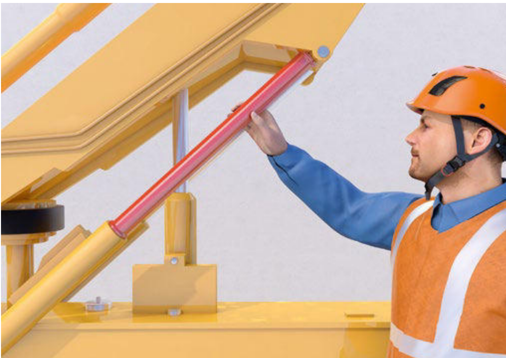
Abb. 95 Formschlüssige Sicherung des Hubgerüsts durch Abstützmanschette
