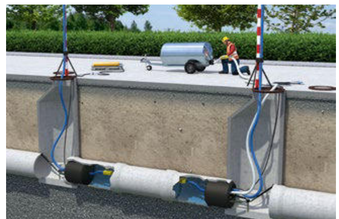
Abb. 120 Durchführung einer Wasserdruckprüfung
