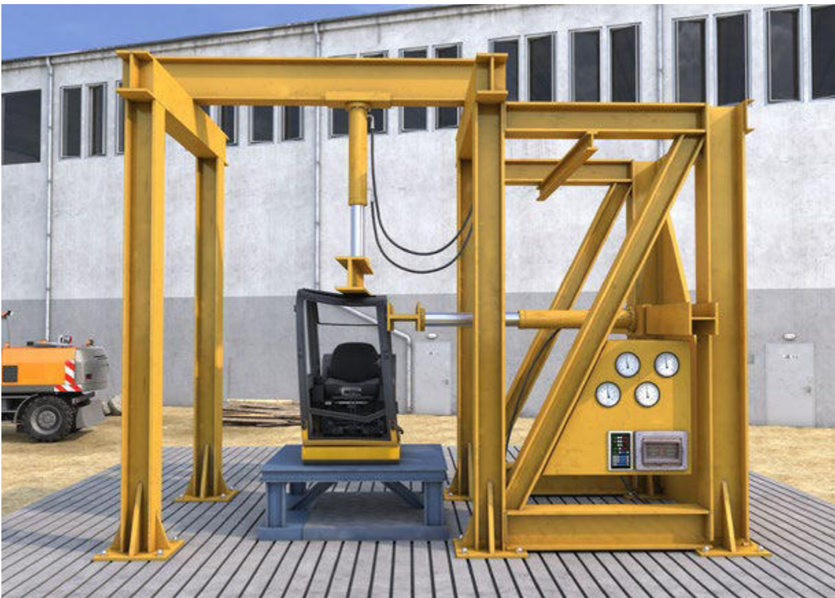
Abb. 81 Baumusterprüfung ROPS (Überrollschutzkonstruktion)
