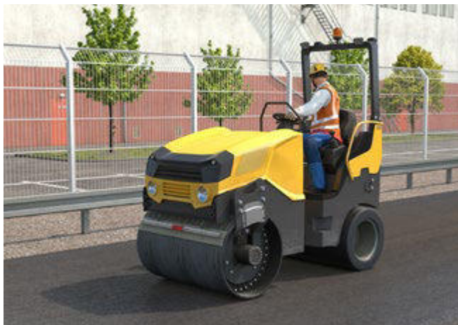
Abb. 102 Bei Umsturzgefahr Überrollschutzeinrichtung und Sicherheitsgurt benutzen
