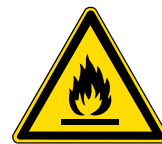
Abb. 40 Warnung vor feuergefährlichen Stoffen Warnzeichen W021
