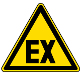
Abb. 126 Warnung v. explosionsgefährlicher Atmosphäre
