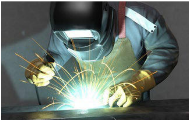
Abb. 65 Schweißen nur mit Schutzausrüstungen
