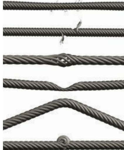
Abb. 60 Beispiele für Ablegekriterien von Drahtseilen
