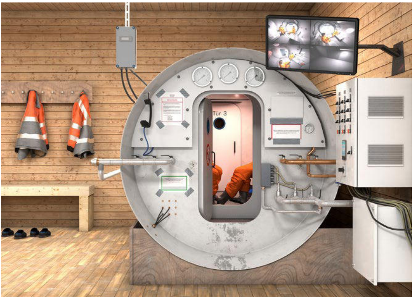
Abb. 144 Personenschleuse bei Arbeiten in Druckluft
