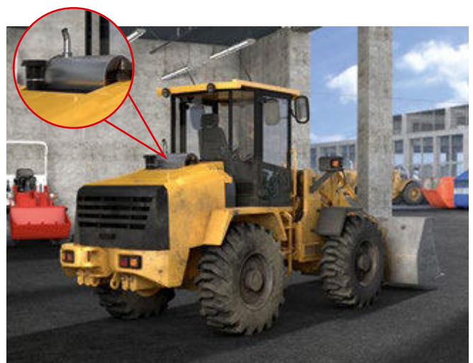
Abb. 96 Nachträglich montierter DPF ohne Beeinträchtigung der Sicht
