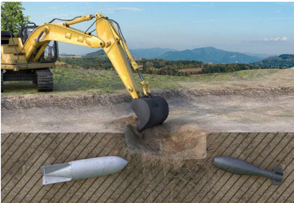
Abb. 22 Kampfmittel im Baugrund
