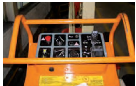
Bild 6-3: Schutzbügel gegen unbeabsichtigtes Betätigen der Bedienelemente
