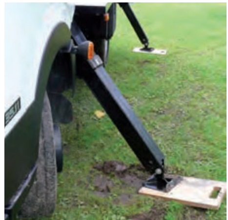
Bild 4-4: Gute (hinten) und schlechte (vorne) Abstützung
