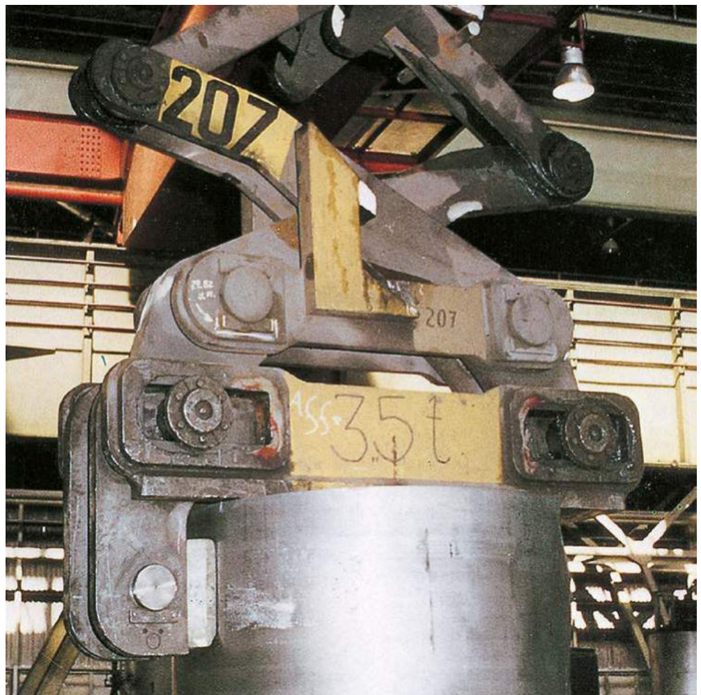
Bild 5-5: Coil wird in der Coilzange nur durch Reibkräfte gehalten
