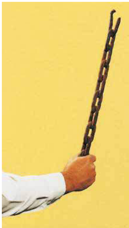
Bild 23-11: Durch Überlastung steif gezogene Kette
