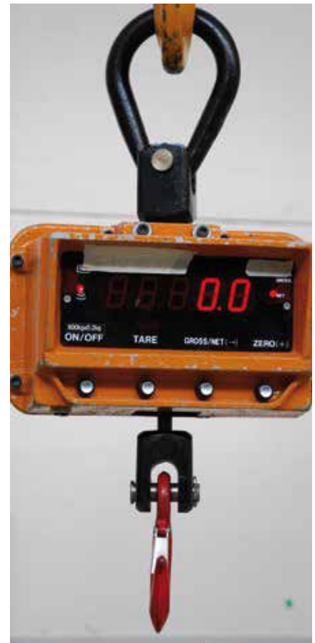
Bild 5-2: Batteriegetriebene digitale Kranwaagen sind leicht transportabel und gut ablesbar
