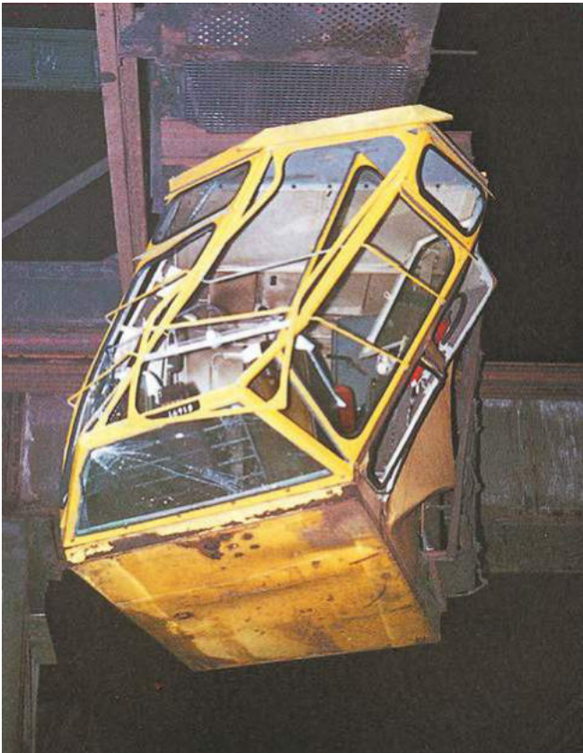
Bild 4-7: Bei der Kranfahrt stieß die Unterkante des Führhauses an zu hoch gelagertes Material
