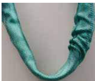
Bild 23-17: Verformung durch Wärme
