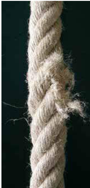
Bild 23-7: Zerstörung einer Litze
