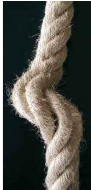
Bild 23-8: Durch Klenke zerstörter Litzenverbund
