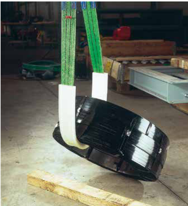
Bild 10-2: Nur der verschiebbare, innen armierte Polyurethan-Schutzschlauch mit starker, mindestens 5 mm dicker Beschichtung ermöglicht das gefahrlose Wenden des Coils, wenn das Band deutlich länger ist als der Kantenenschutzschlauch
