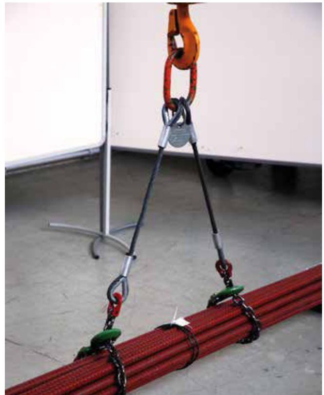
Bild 6-1: Kombination Seil/Kette zur Schonung der Drahtseile
