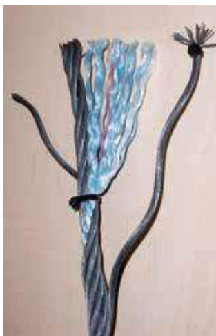
Bild 8-2: Aufbau eines Litzenseiles
