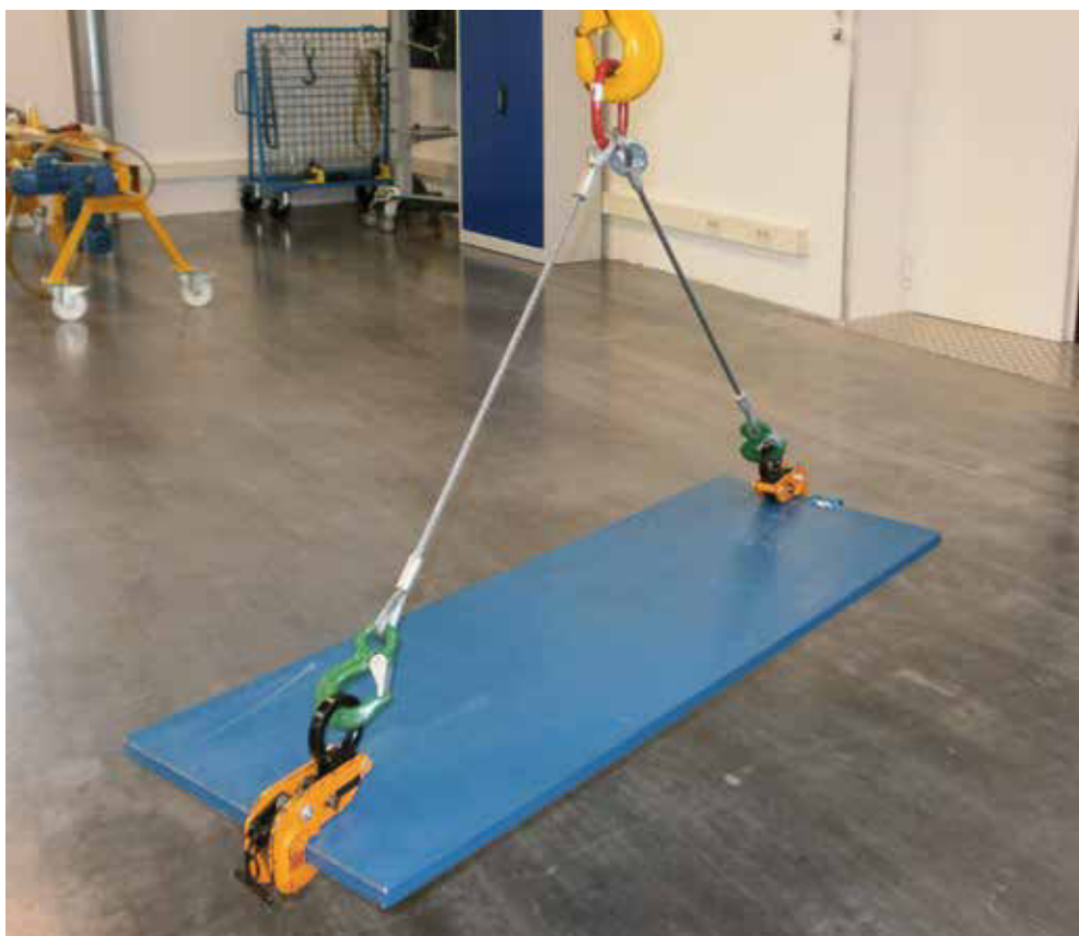
Bild 13-1: Blech horizontal sicher transportiert
