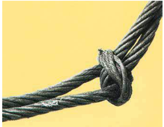
Bild 9-2: Unzulässiger Knoten zerstört den Seilverbund
