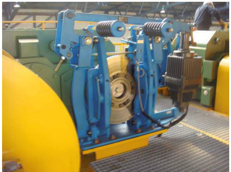
Bild 4-5 Inaugenscheinnahme einer Scheibenbremse
