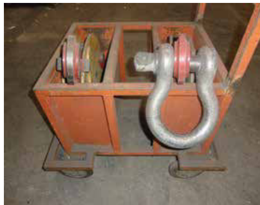
Bild 24-2: Abgestellte, gegen Umfallen gesicherte Lastaufnahmemittel
