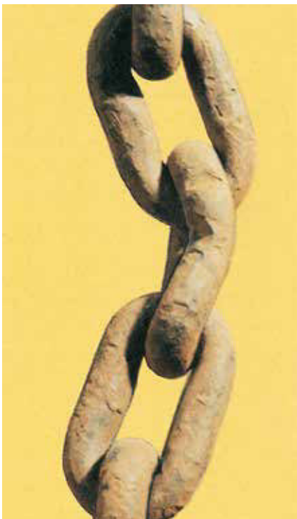
Bild 23-10: Kette mit verbogenem und eingekerbtem Kettenglied
