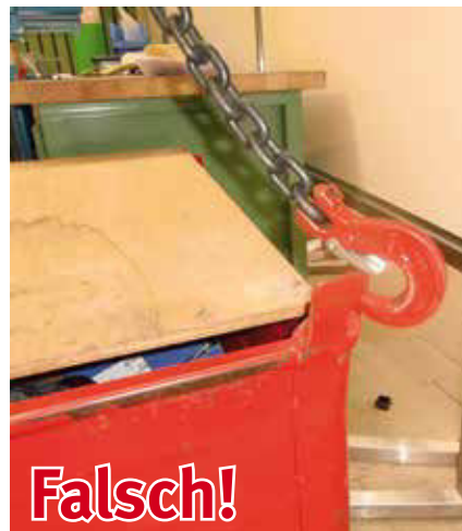
Bild 16-4: Haken rutschen bei Schlaffketten aus den Ösen
