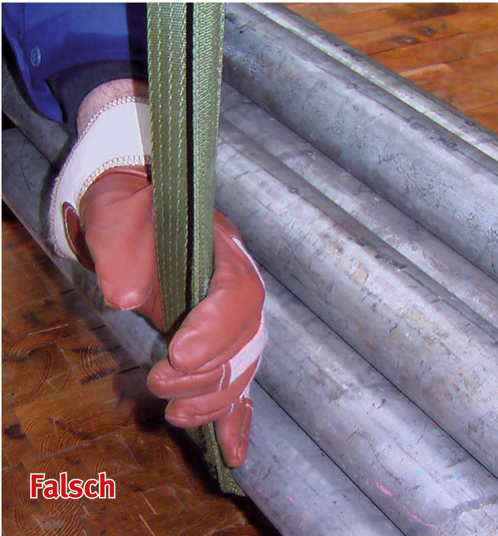
Bild 5-17: Die Reibung zwischen Last und Ketten ist so gering, dass die Ketten beim Anheben zusammenrutschen und die Last aus den Ketten fällt
