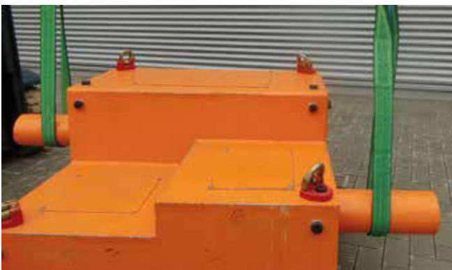
Bild 6-2: Hebebänder sind oberflächenschonend
