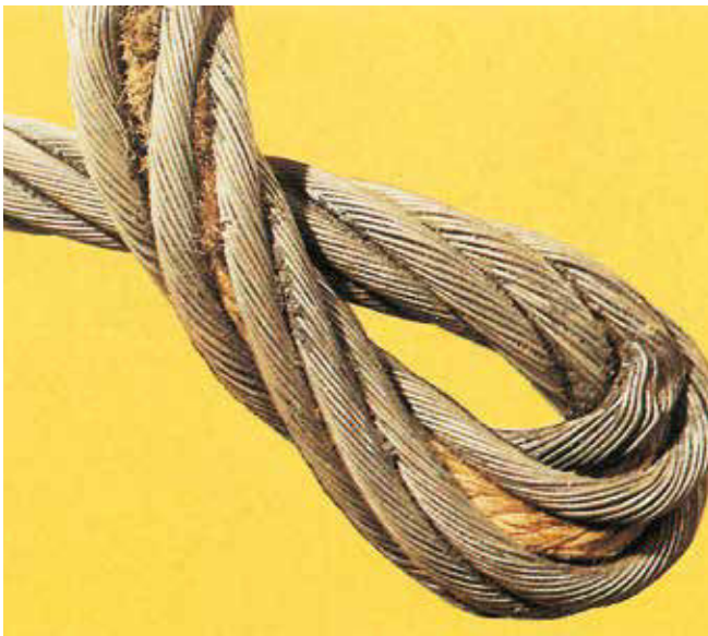
Bild 23-4: Kinken/Klanken und Eindrückung einer Litze. Der Seilverbund ist zerstört: Ablegen!
