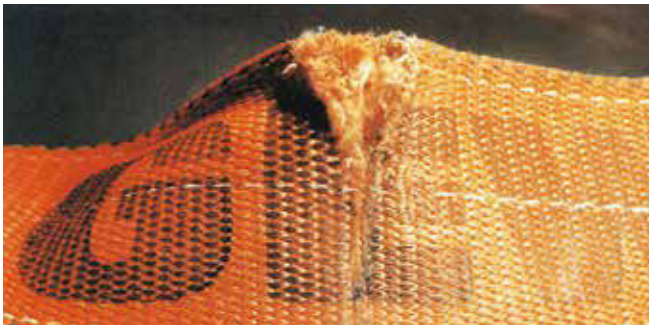
Bild 23-14: Durch scharfkantige Last eingeschnittenes Hebeband
