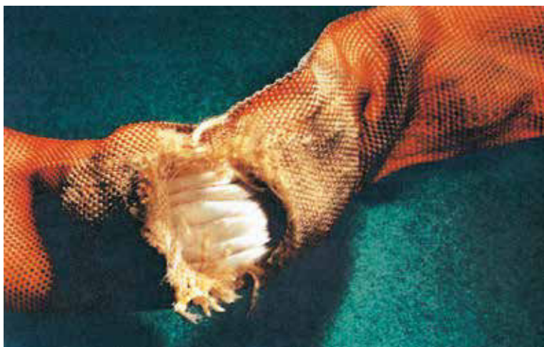
Bild 23-16: Durch Wärmeeinfluss zerstörte Ummantelung
