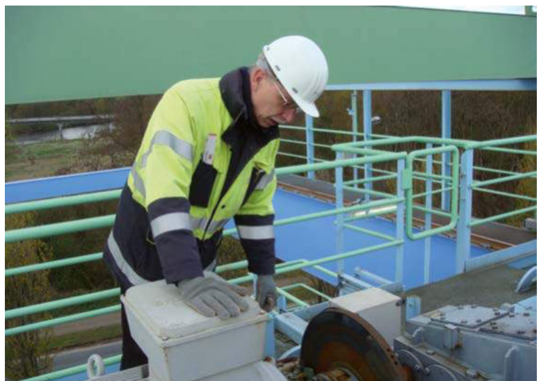
Bild 4-6: Der Kranführer nimmt die Bremse in Augenschein
