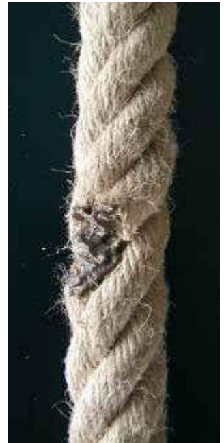
Bild 23-9: Wärmeeinfluss hat eine Litze zerstört
