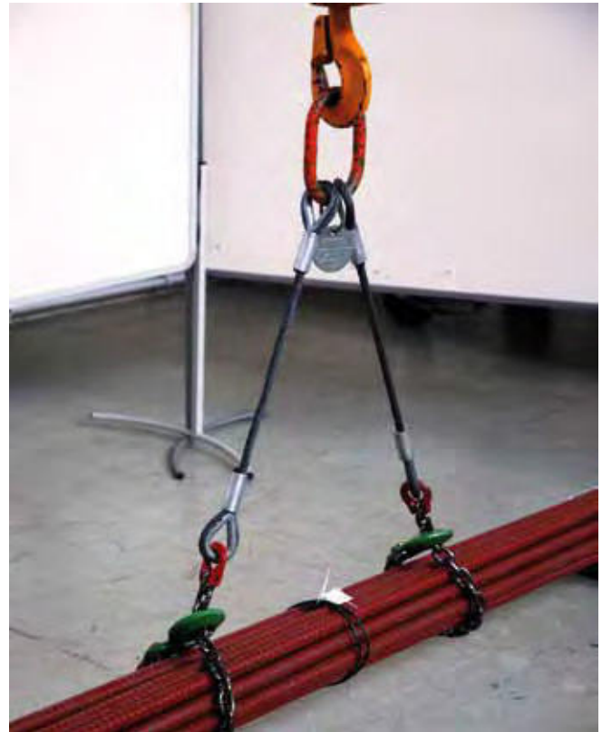
Bild 6-1: Kombination Seil/Kette zur Schonung der Drahtseile
