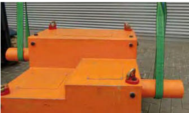
Bild 6-2: Hebebänder sind oberflächenschonend
