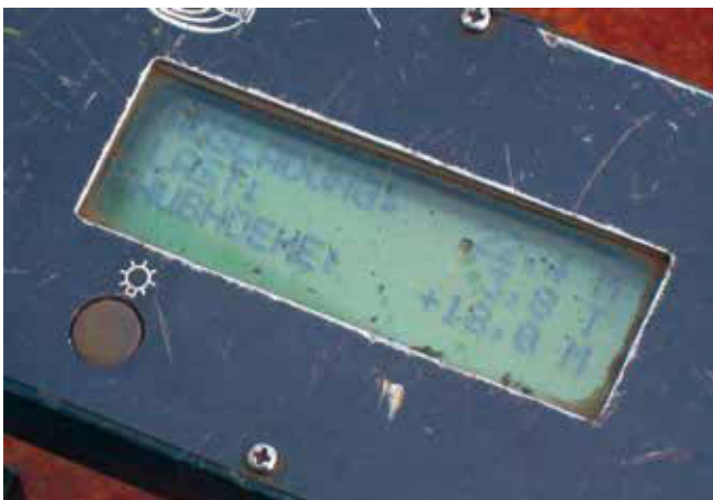
Bild 5-3: Steuerbirne mit digitaler Lastanzeige
