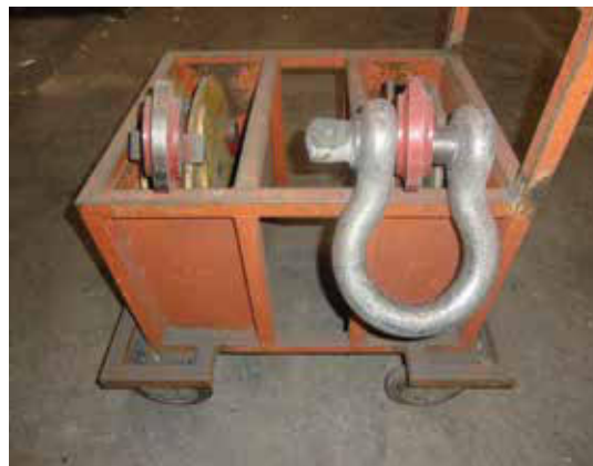
Bild 24-2: Abgestellte, gegen Umfallen gesicherte Lastaufnahmemittel
