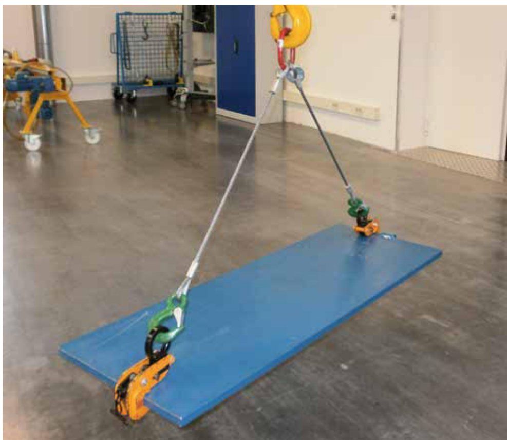
Bild 13-1: Blech horizontal sicher transportiert
