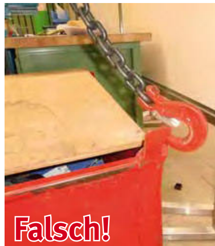
Bild 16-4: Haken rutschen bei Schlaffketten aus den Ösen
