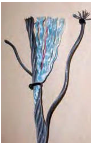
Bild 8-2: Aufbau eines Litzenseiles
