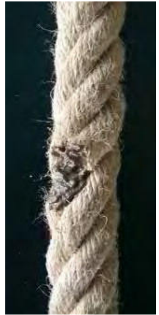
Bild 23-9: Wärmeeinfluss hat eine Litze zerstört
