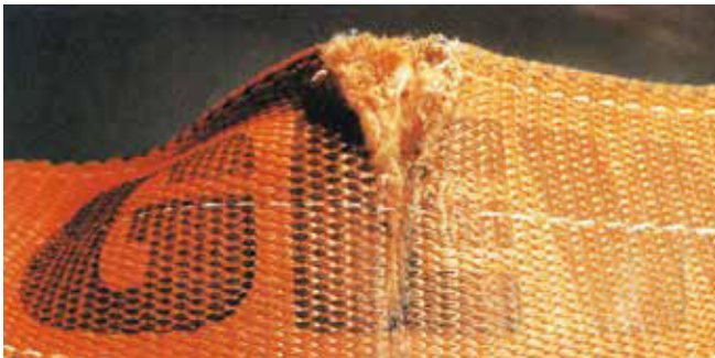
Bild 23-14: Durch scharfkantige Last eingeschnittenes Hebheband
