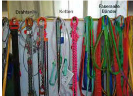
Bild 24-1: Vorbildliche Aufbewahrung von Seilen und Ketten
