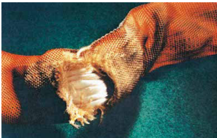
Bild 23-16: Durch Wärmeeinfluss zerstörte Ummantelung
