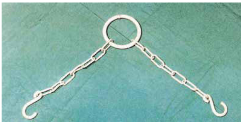
Bild 11-1: Eine langgliedrige Kette darf selbst im Neuzustand nicht als Anschlagmittel verwendet werden. Die Kettenglieder verbiegen!
