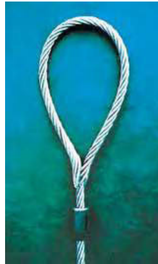
Bild 9-7: Die beiden Enden sind gegeneinander verseilt
