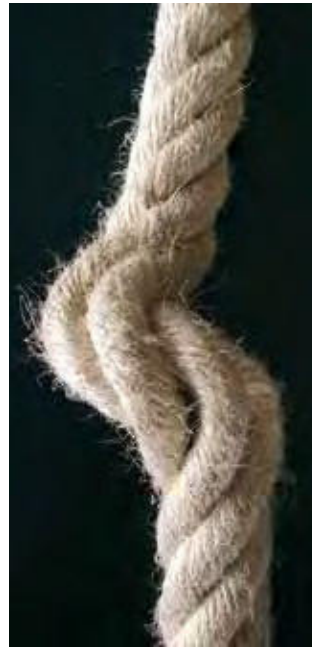
Bild 23-8: Durch Klenke zerstörter Litzenverbund
