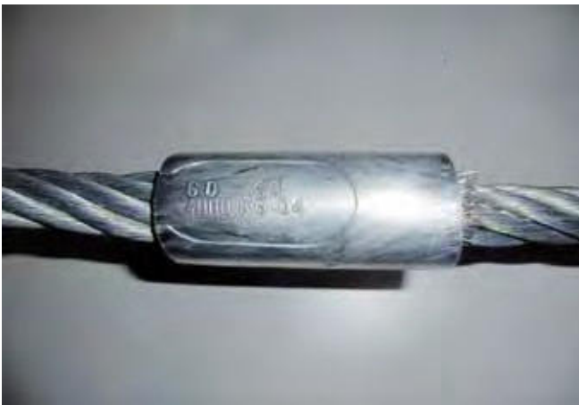
Bild 9-1: Pressklemme mit Verpresserkennzeichen
