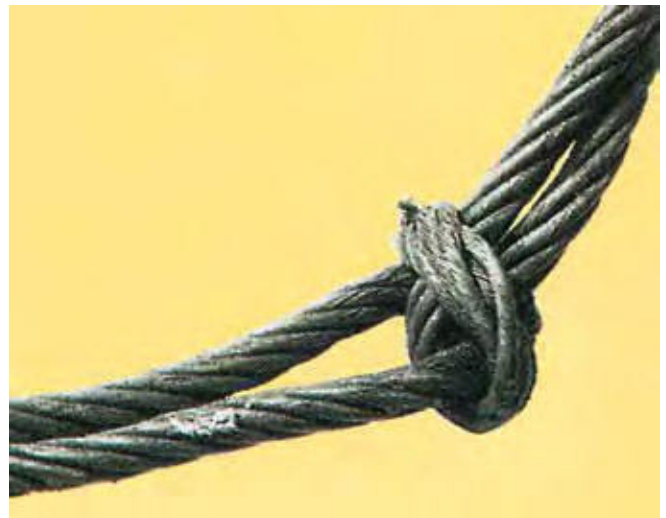
Bild 9-2: Unzulässiger Knoten zerstört den Seilverbund
