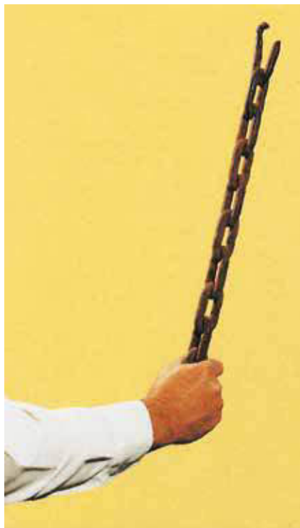
Bild 23-11: Durch Überlastung steif gezogene Kette
