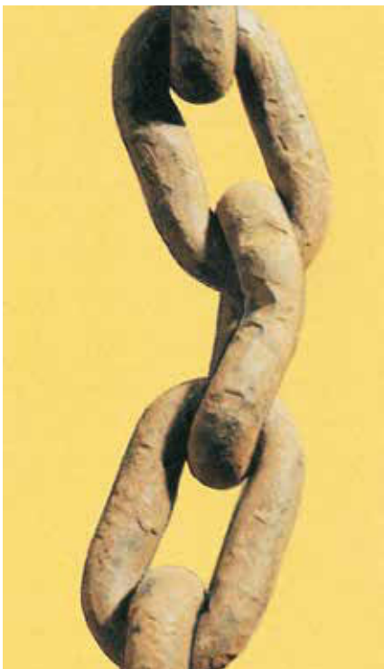
Bild 23-10: Kette mit verbogenem und eingekerbtem Kettenglied
