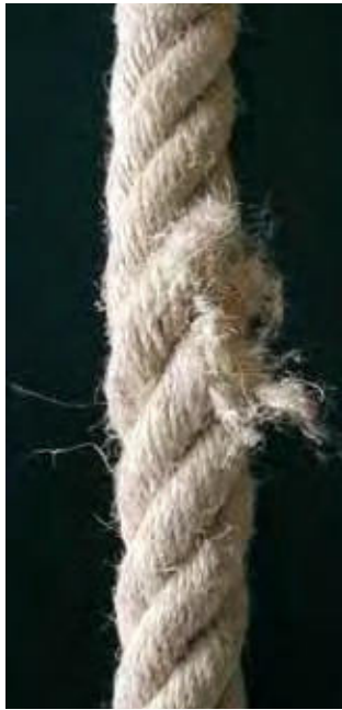
Bild 23-7: Zerstörung einer Litze
