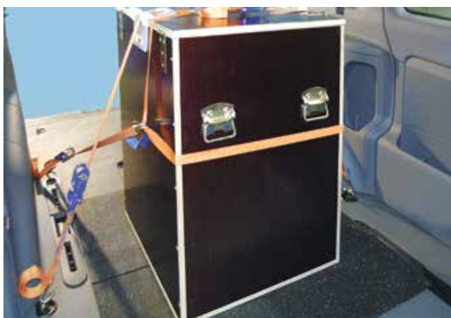
Abb. 10-4 Kombination aus Kopfschlinge, Niederzurren und RHM
