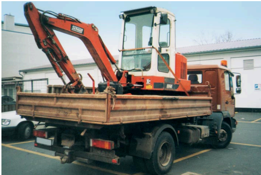
Bild 41: Nicht zulässige Sicherung eines Minibaggers durch Niederzurren auf einem LKW
