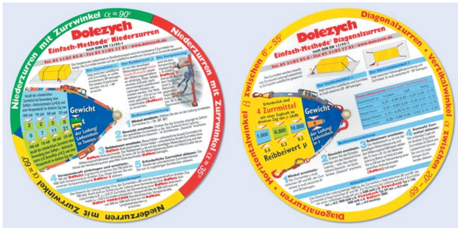
Bild 40: Schablone „Trucker-Disc“ zur Ermittlung der Anzahl der erforderlichen Zurrgurte
