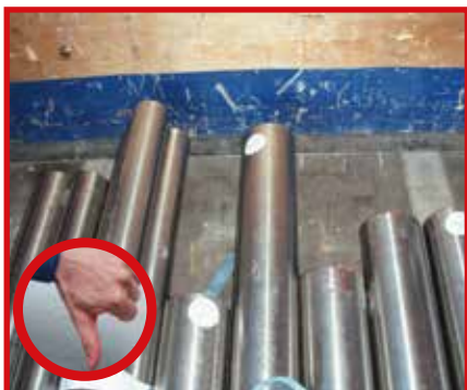
Abb. 7-7 / 7-8 Ladelücken geben der Ladung den Platz, sich zu bewegen – und das oft mit dramatischer Auswirkung.
