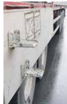
Abb. 2-23 / 2-24 Geländer, Haltegriffe, Laufstege, Stand- und Arbeitsflächen sowie abnehmbare Absturzsicherungen müssen genutzt werden.
