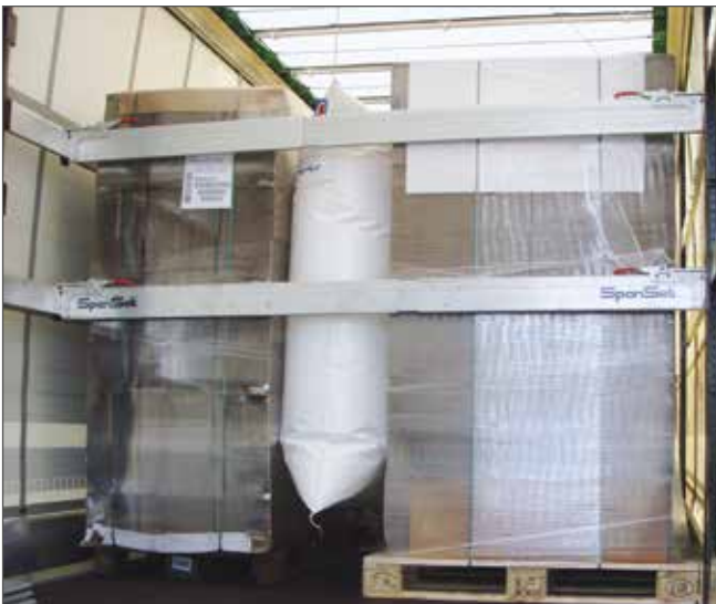
Abb. 6-65 Airbags sind hoch belastbare, mit Luft gefüllte Staupolster.
