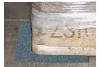
Abb. 3-10 Anti-Rutsch-Material zwischen Trailerboden und Palette.
