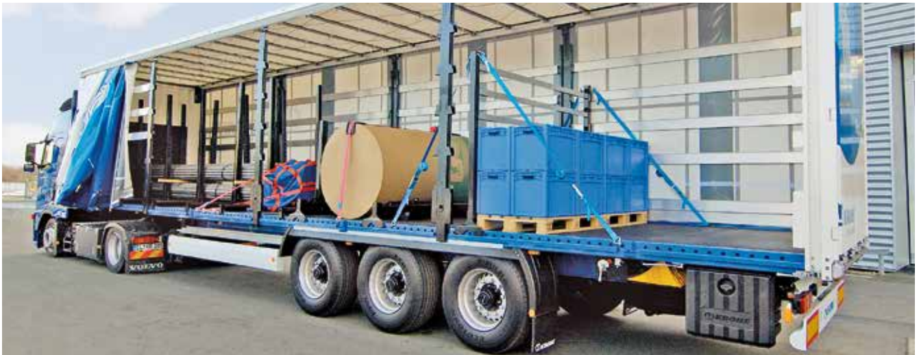
Abb. 5-21 Verstärkter Aufbau (Code XL)
