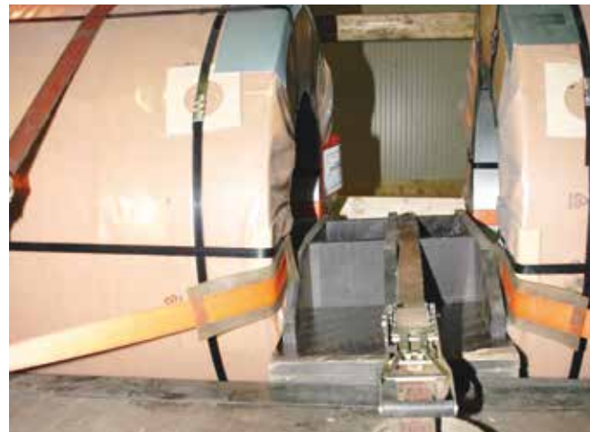
Abb. 10-66 Muldenabdeckbretter als Abstandhalter und Gurte mit Kantenschutz
