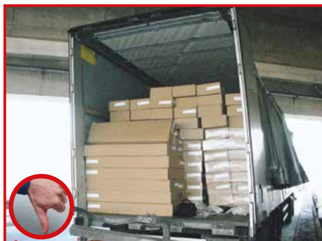
Abb. 10-51 Schnell überlastet: Planenaufbauten
