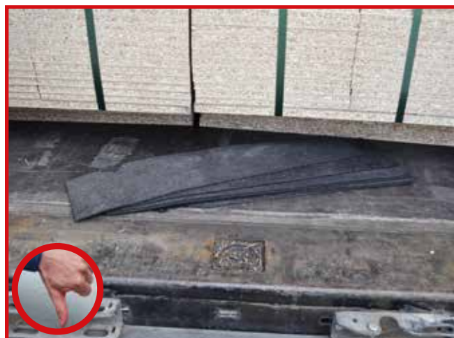
Abb. 10-38 Gehören unter die Ladung und nicht daneben: Anti-Rutsch-Matten
