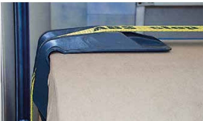
Abb. 6-16 Die Hohlkehle verhindert eine Beschädigung des Ladeguts.
