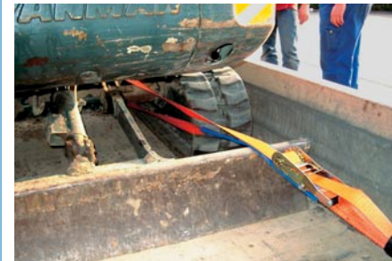
Bild 50: Sicherung am Fahrwerk
