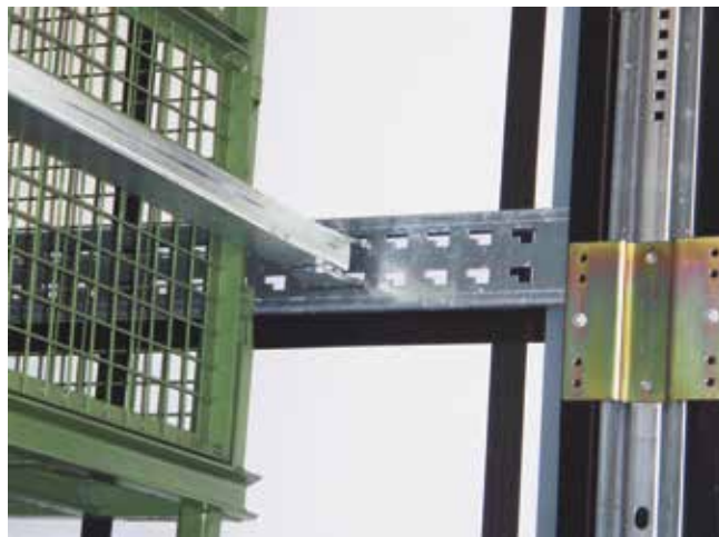
Abb. 10-59 Kann deutlich mehr Ladung sichern: Sperrbalken
