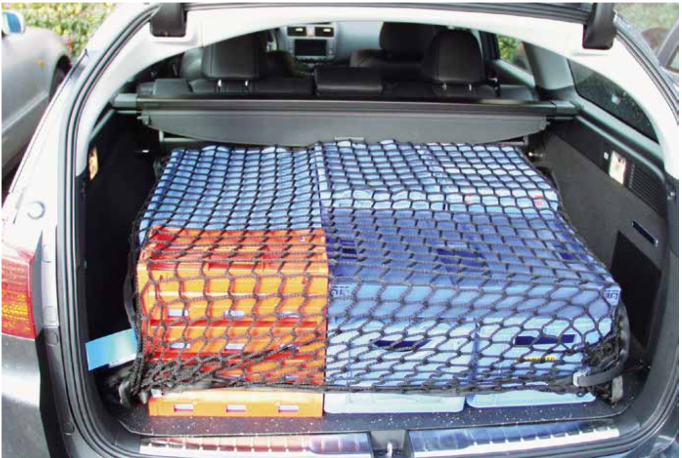
Abb. 10-1 Ladungssicherung im Pkw mit Hilfe eines Sicherungsnetzes
