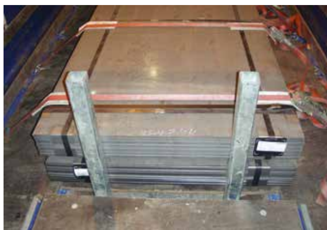
Abb. 10-101 Formschluss in Fahr-richtung durch Steckungen
