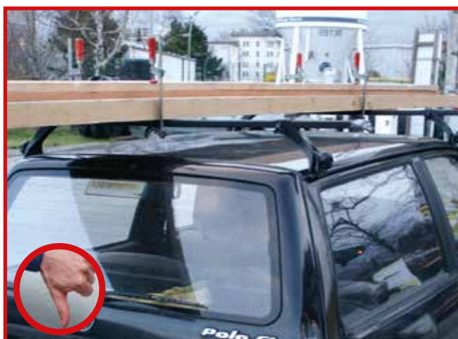
Abb. 10-5 Schraubzwingen sind keine Ladungssicherungshilfsmittel
