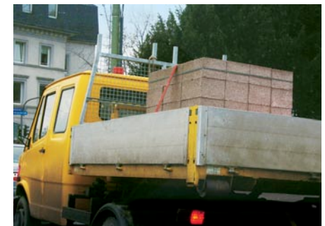
Bild 52: Versuchte Ladungssicherung eines Steinpaketes mit einem Zurrgurt
