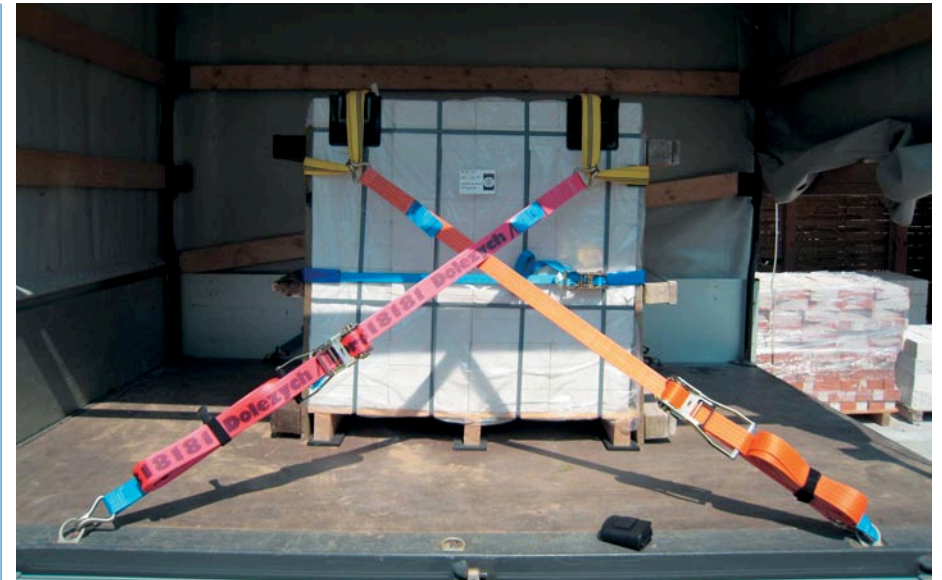
Bild 34: Sicherung eines Steinpaketes auf der Ladefläche durch Rundschningen als Kopflaschen sowie rutschhemmende Materialien
