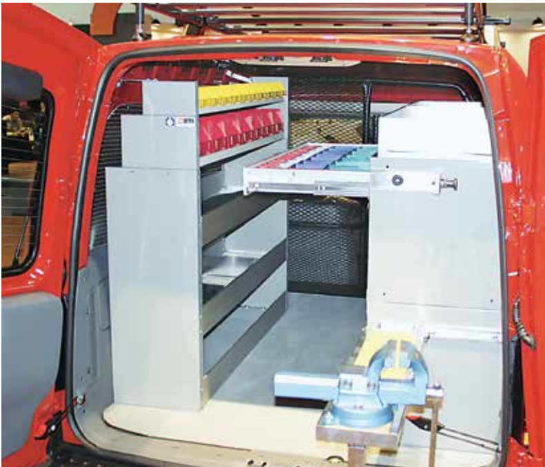
Abb. 6-49 Diese branchenspezifische Fahrzeugeinrichtung bietet für Handwerksbetriebe durchdachten Stauraum für Werkzeug und Material.
