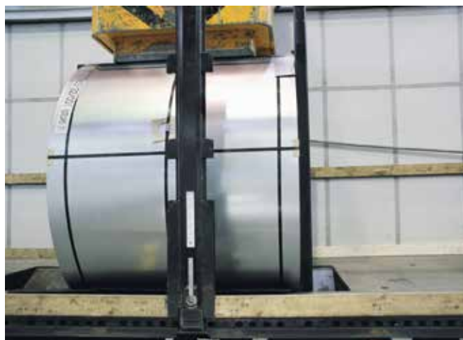
Abb. 10-65 Positionieren eines Coils gegen Steckungen
