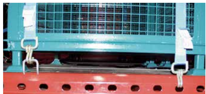
Abb. 5-30 Durch variable Zurrpunktsysteme können schwere Einzellasten dem Lastverteilungsplan entsprechend punktgenau platziert und gesichert werden.
