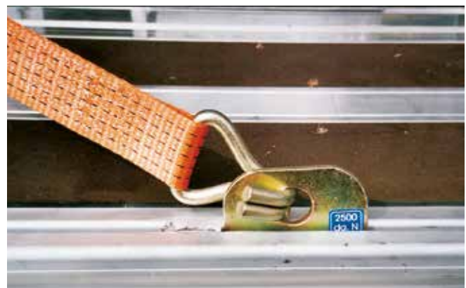
Abb. 5-29 Rungentaschenreihe mit Zurrloch; Belastung Zurrlöcher 2.000 daN
