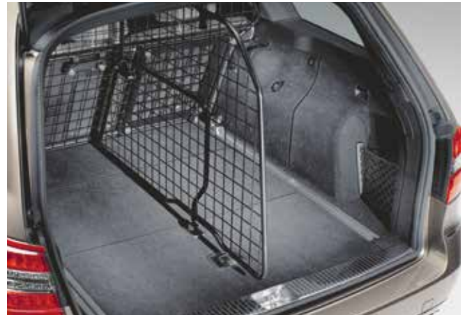
Abb. 6-45 Kombinierbare Stahlgitter (Raumteilung/Schutz des Fahrgastraums)
