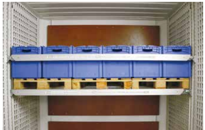
Abb. 6-54 Ankerschiene mit Ladebalken
