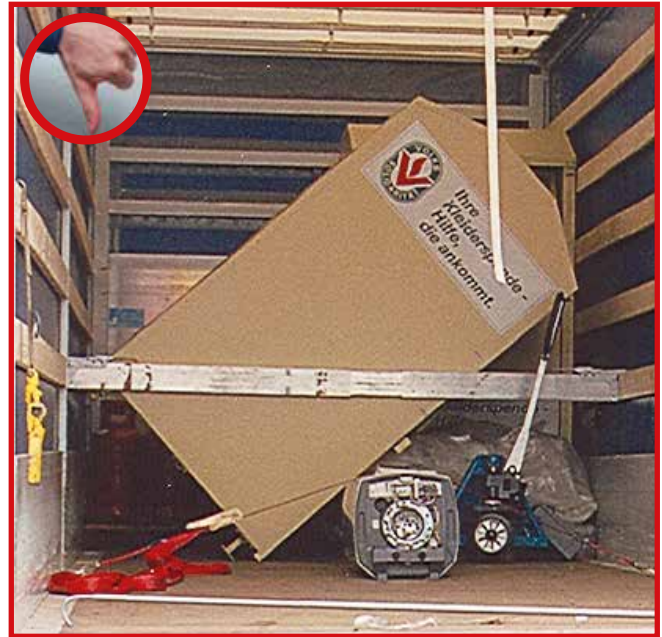
Abb. 8-43 Eine nicht standfeste Ladung kann eine große Gefahr darstellen, denn infolge des Fahrbetriebs ist es möglich, dass die Ladung plötzlich im oder vom Fahrzeug kippt.
