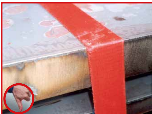
Abb. 10-73 Ohne Kantenschutz: Gurte werden zerschnitten
