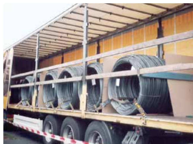
Abb. 10-87 Jede Rolle mit zwei Kopfschlingen sichern
