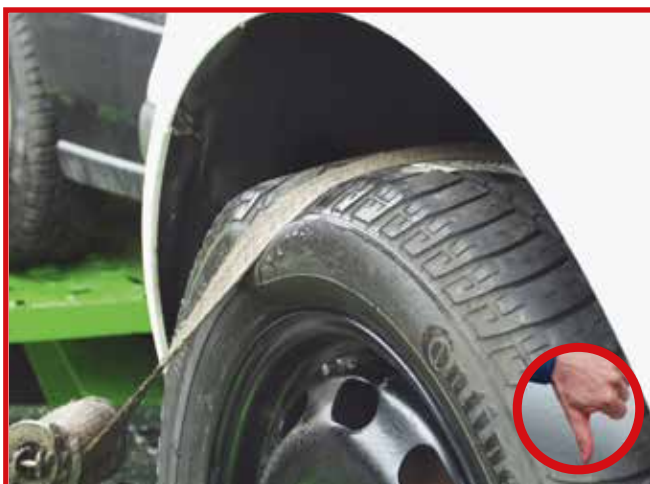
Abb. 10-107 Falsche Gurtführung: Reifen kann Schaden nehmen
