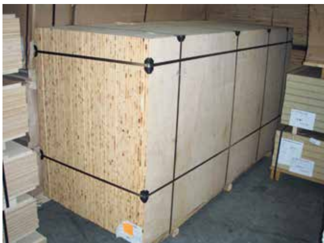
Abb. 10-35 Mit Umreifungsbändern paketierte Ladeinheiten
