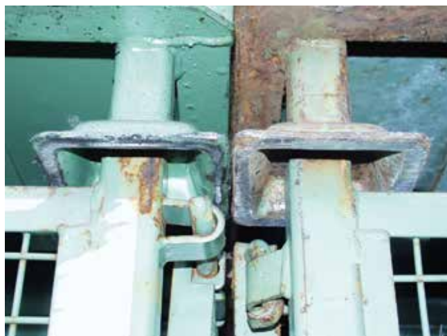
Abb. 10-58 Hier formschlüssig gestapelt: Gitterboxen
