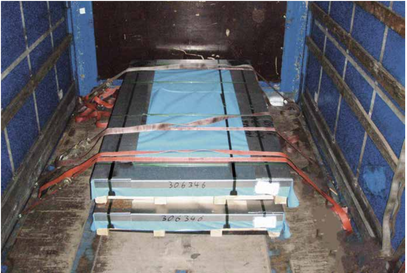
Abb. 10-96 Formschluss in Fahrtrichtung durch die Stirnwand
