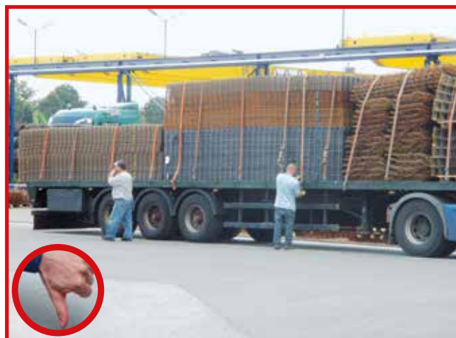
Abb. 10-80 Betonstahlmatten auf diese Weise nicht gesichert
