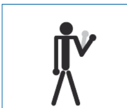
Links fahren Von der einweisenden Person aus gesehen: Den linken Arm in horizontaler Haltung leicht anwinkeln und seitlich hin- und herbewegen*
