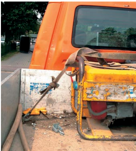
Bild 23: Nicht zulässiges Knoten von Zurrgurten
