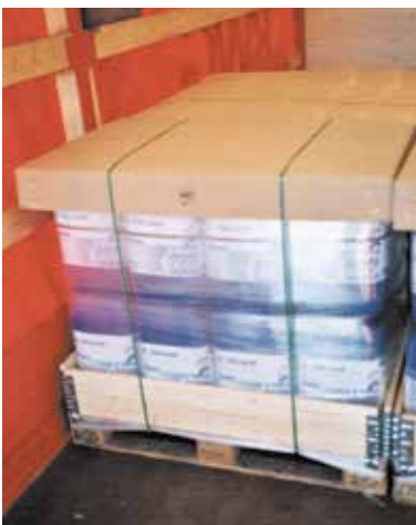
Abb. 1-24 Diese Palette wurde durch einen Steckaufsatz aus Holz optimiert. Die Ladegüter wurden mit Stretchfolie umwickelt und mit einem Karton abgedeckt. Als zusätzliche Ladegutsicherung wurden Bänder angebracht. Diese palettierte Ladeinheit ist für den Straßentransport beförderungssicher vorbereitet.
