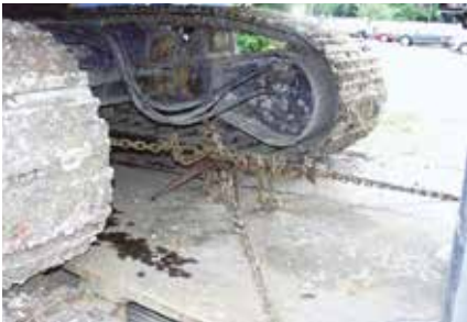
Abb. 7-48 Ladungssicherung durch Diagonalzurren
