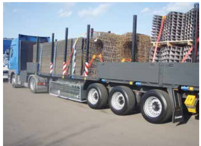
Abb. 10-76 Kombination aus Formschluss und Niederzurren
