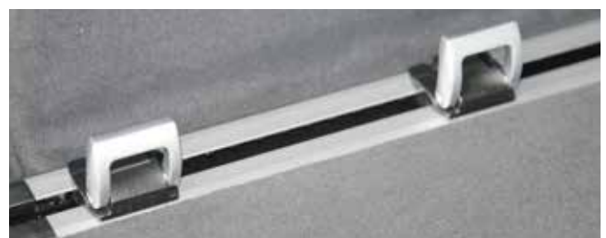
Abb. 6-48 Variable Zurrpunkte im Schienensystem
