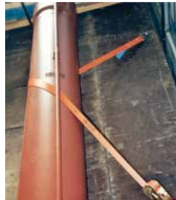
Abb. 7-38 Zur seitlichen Sicherung sind mindestens drei solcher Umreifungszurren erforderlich: eine zu einer Seite und zwei zur anderen Seite.
