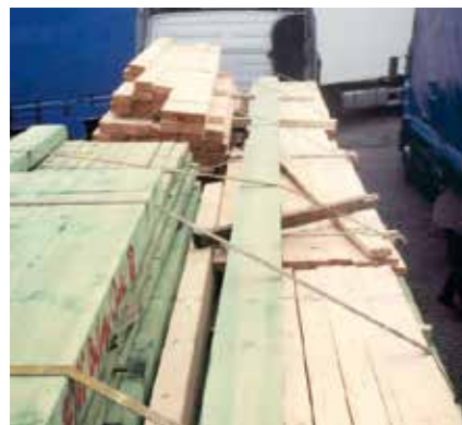
Abb. 7-22 Niederzurren ist nur wirksam, wenn alle Ladungsteile durch die Zurrmittel erfasst und dann durch die Vorspannkraft ausreichend fest auf die Ladefläche gepresst werden.
