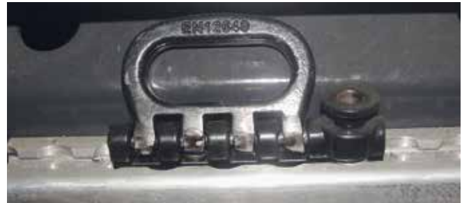
Abb. 5-28 Zurrschienensystem mit Rasterabstand
