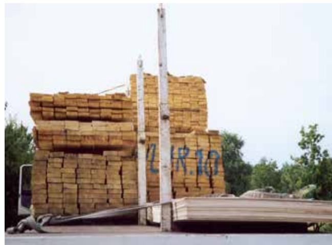
Abb. 10-31 Fixieren durch Mittelrungen
