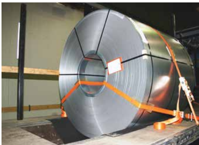
Abb. 10-64 Zurrgurte zur rückwärtigen Sicherung nach vorn abspannen
