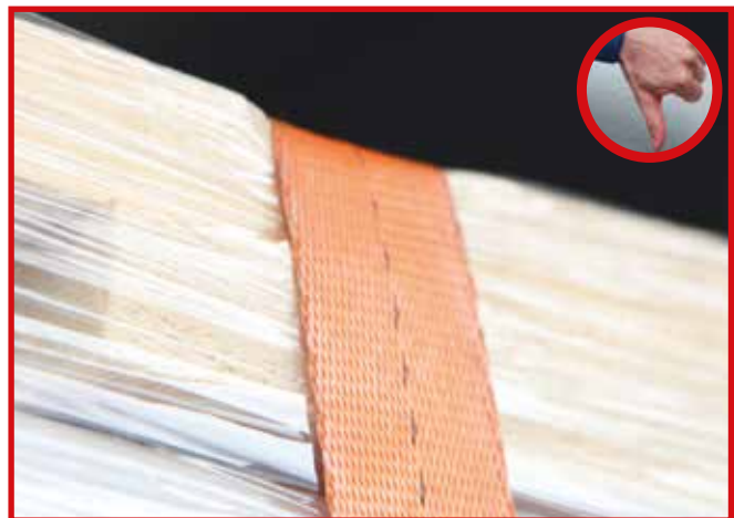
Abb. 6-19 Ohne Kantenschutz: Die Kopfpalette wird eingedrückt, daher ist keine gleichmäßige Vorspannkraftverteilung im Zurrgurt möglich. Zudem kann der Zurrgurt beschädigt werden, in diesem Beispiel durch einen Palettennagel.
