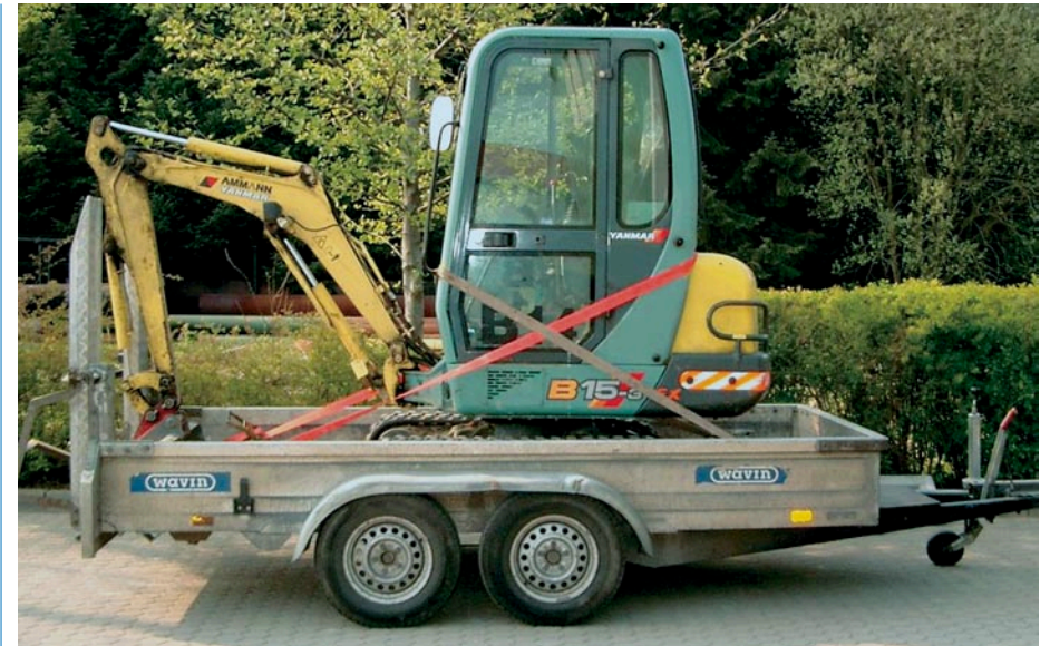
Bild 43: Versuchte Diagonalzurrung an der Fahrerkabine ohne Zurrpunkte!
