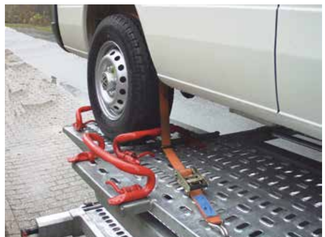
Abb. 10-105 Drei-Punkt-Zurrgurt in Kombination mit Radvorlegern
