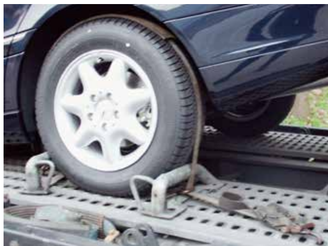
Abb. 10-109 Richtige Position für Drei-Punkt-Zurrgurt
