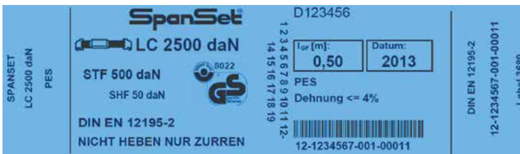
Abb. 6-3 Zurrgurte müssen mit einem rechteckigen gut lesbaren Etikett versehen sein.
