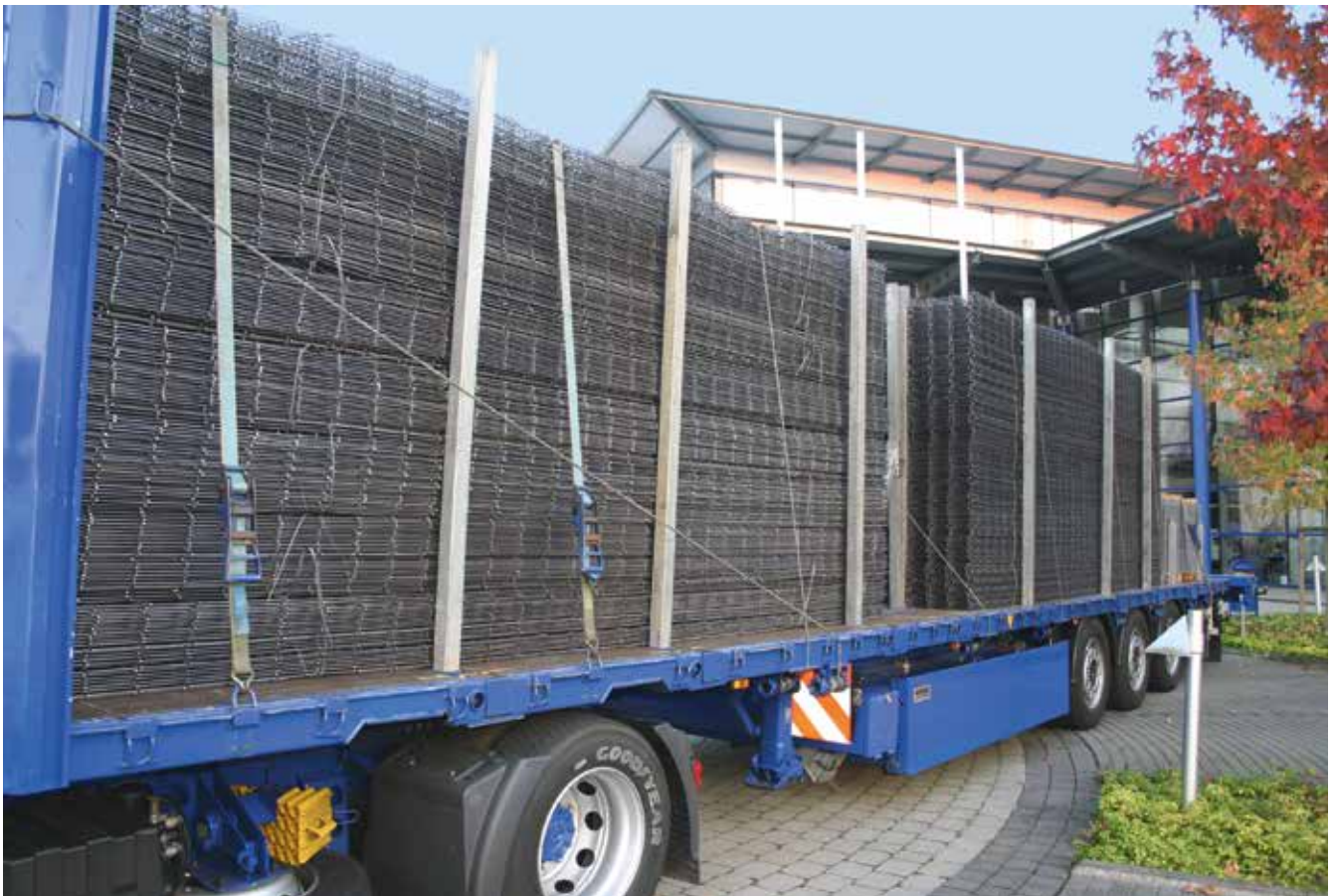
Abb. 10-74 Formschluss durch Steckungen
