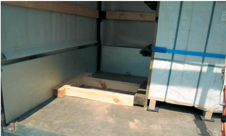
Bild 37: Mittels Holzkonstruktion formschlüssige Sicherung durchgeführt
