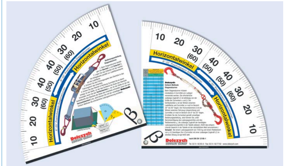
Bild 38: Horizontal-Winkelmesser zur Winkelbestimmung für die Ermittlung der Anzahl der erforderlichen Zurrgurte aus der Tabelle
