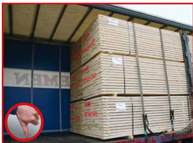
Abb. 10-43 Kein Formschluss in Fahrtrichtung
