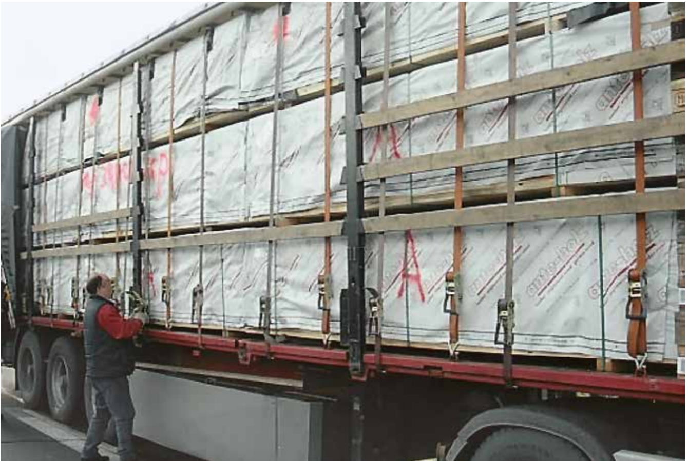
Abb. 10-39 Sicherung durch Niederzurren
