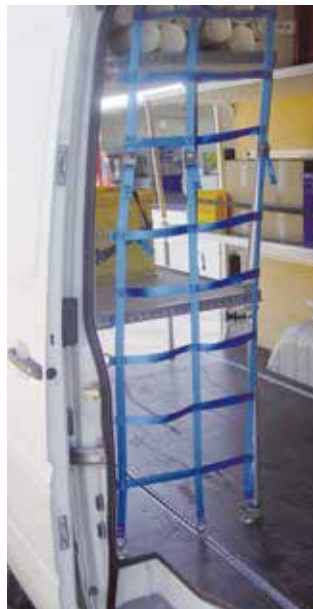
Abb. 6-50 Ein Gurtnetz bildet den gesamten Regalabschluss
