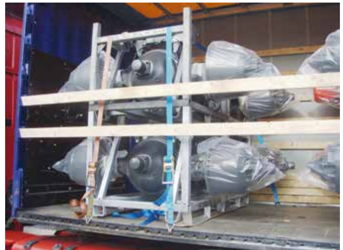
Abb. 10-55 Sicherung von Ladungsträgern durch Niederzurren
