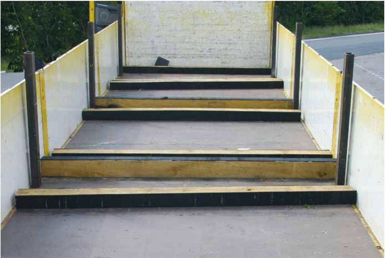
Abb. 10-25 Anti-Rutsch-Balken (müssen noch richtig positioniert werden!)
