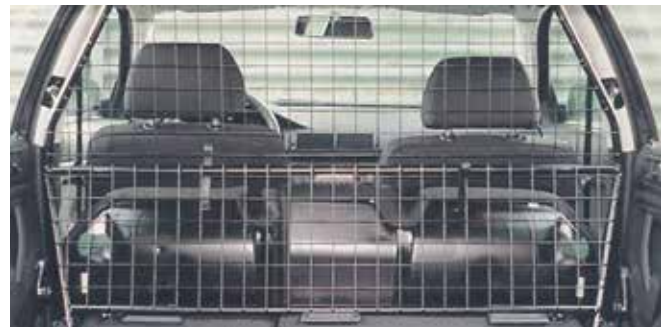
Abb. 6-46 Nachträglich eingebautes Trenngitter nach DIN 75410-2
