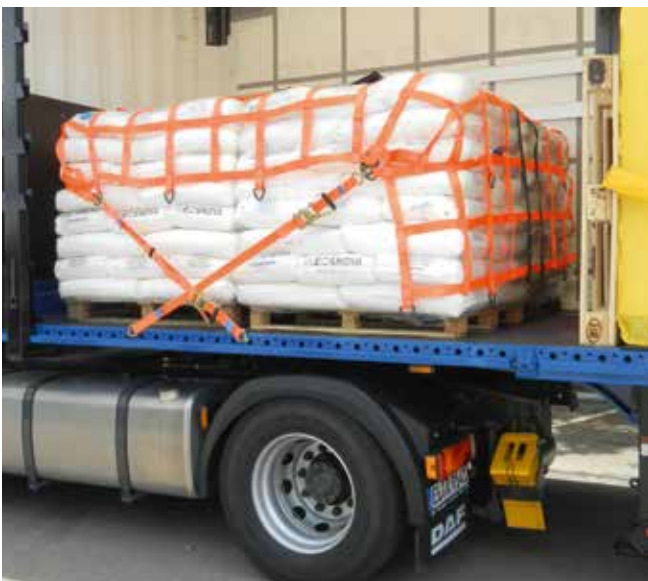
Abb. 6-42 Beispiel für die Sicherung von Sackware
