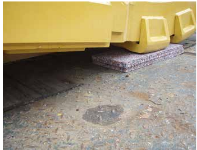
Abb. 6-76 RHM darf auch doppelt gelegt werden.
