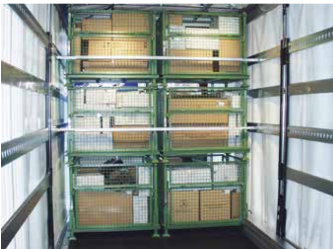
Abb. 10-54 Blockieren mit Sperrbalken
