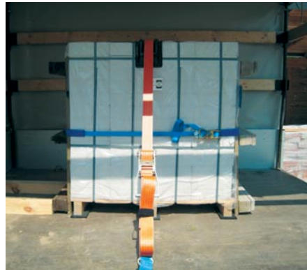
Bild 55: im Niederzurren mit einem Gurt, RHM und Blockieren gesichert
