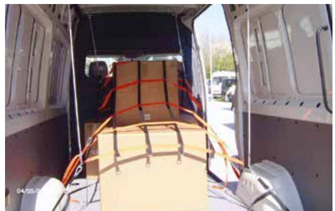
Abb. 6-39 / 6-40 Zurrnetz mit Expandersystem
