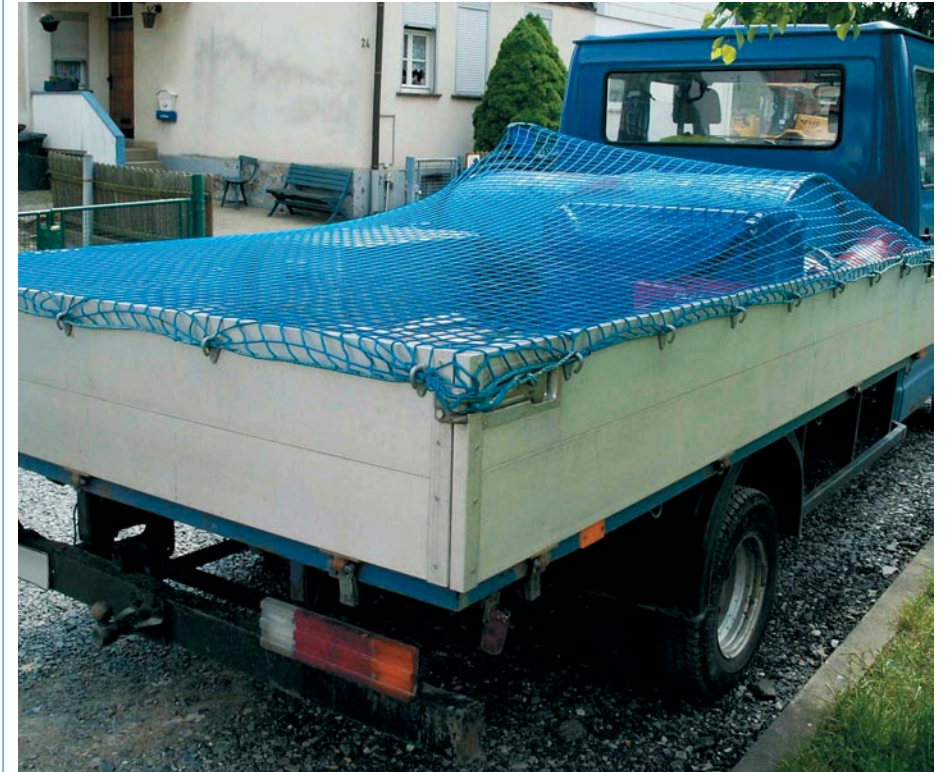
Bild 30: Verwendung von Abdecknetzen, um leichte Ladung am Wegfliegen zu hindern.
