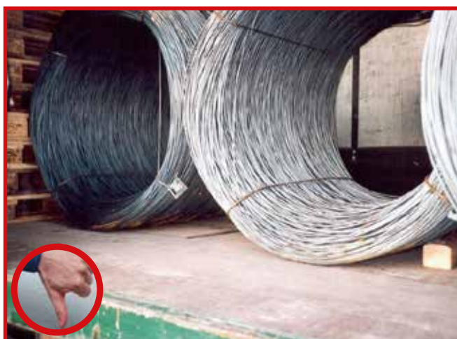
Abb. 10-85 Großes Risiko: ungesicherte Drahtrollen
