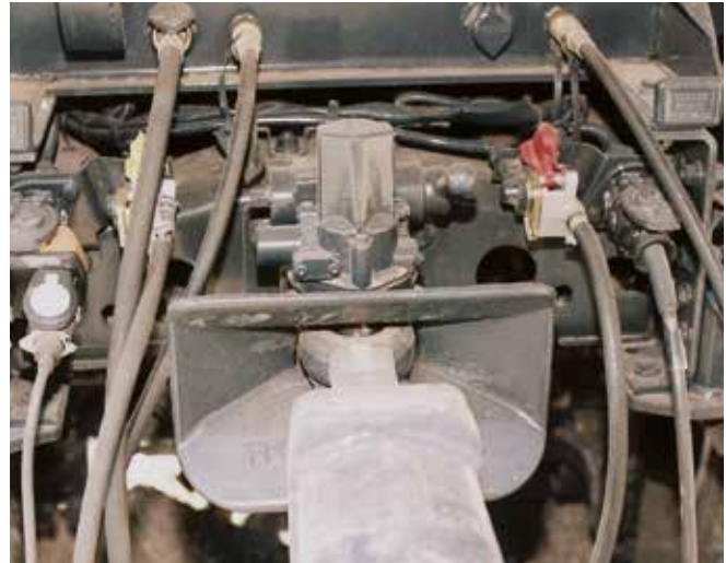
Abb. 2-31 Detailaufnahme einer Bolzenkupplung
