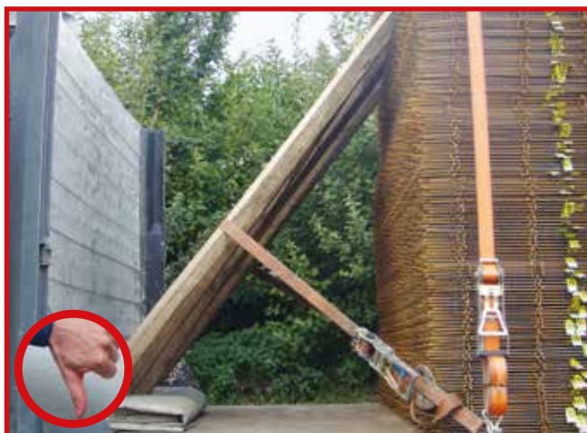
Abb. 10-78 Kein Formschluss auf diese Weise
