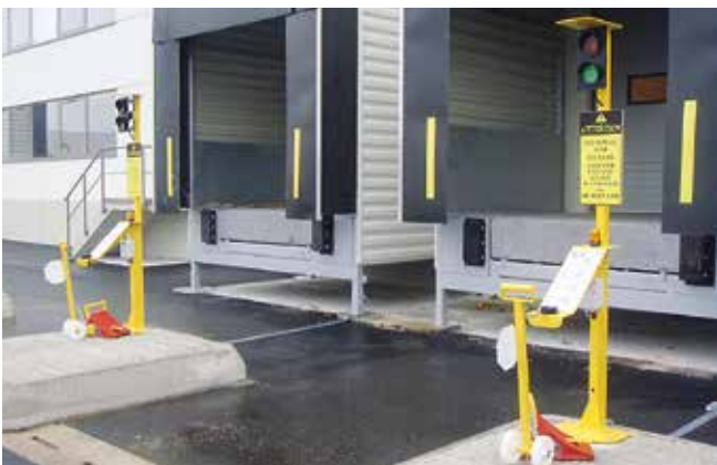
Abb. 2-14 Elektronischer Unterlegkeil mit Ampelsteuerung
