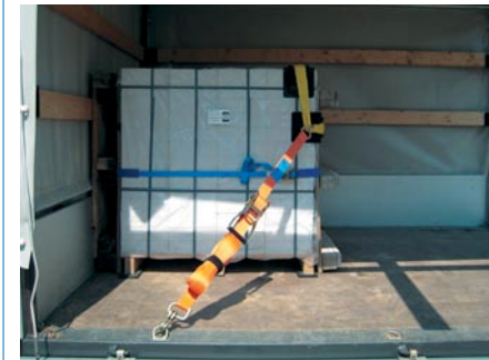
Bild 8: Festsetzen an der Stirnwand
