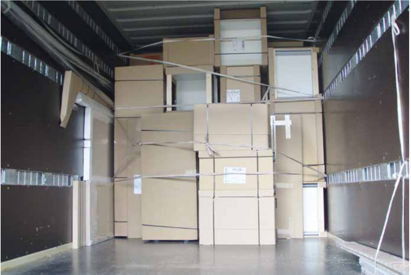
Abb. 10-46 Sicherung durch Direktzurren mit Gurtbändern
