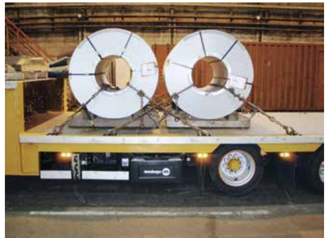
Abb. 10-62 Coils auf Palette – durch Schlingenzurren gesichert
