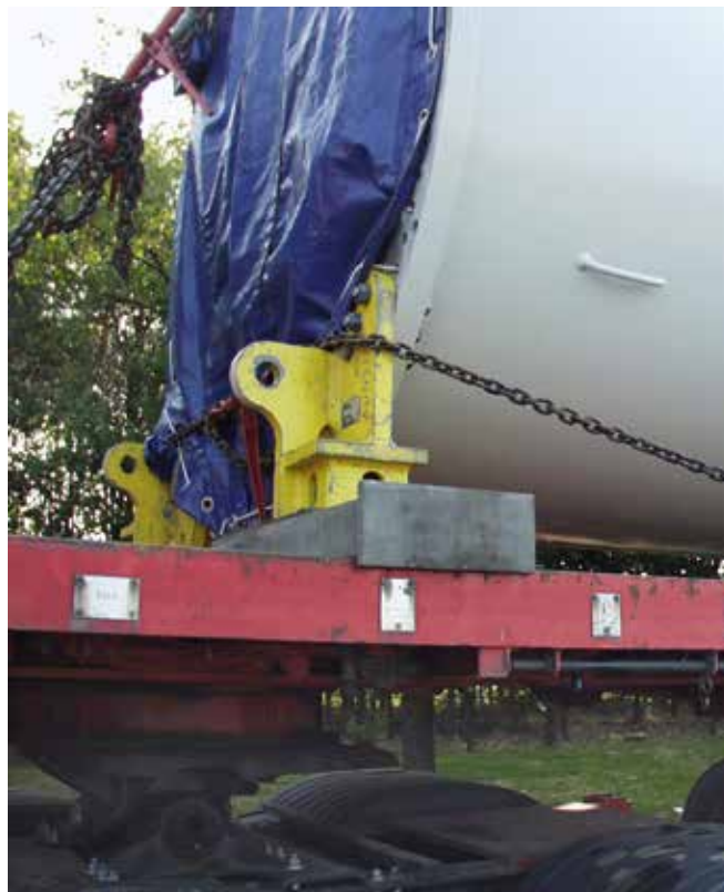
Abb. 7-35 / 7-36 Praxisbeispiele für das Kopfschlingenzurren
