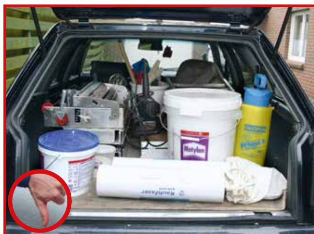
Abb. 10-7 Ungesicherte Ladung gefährdet Insassen
