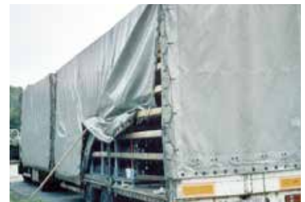
Abb. 7-47 Pritsche mit Plane und Spriegel
