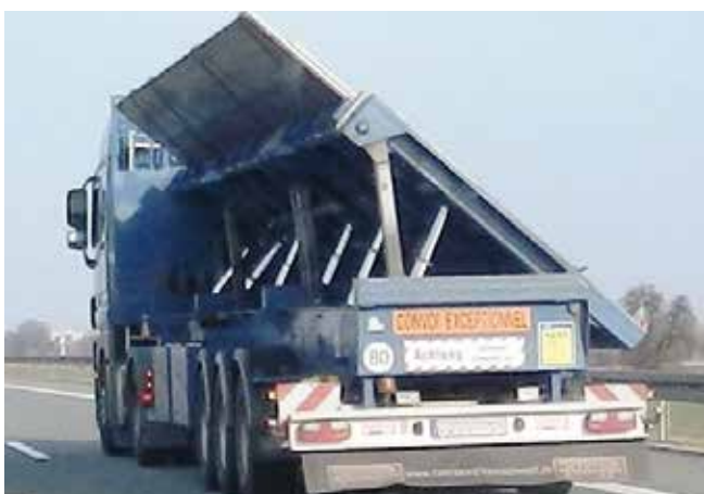
Abb. 10-70 Überbreite Bleche auf einem Schrägbock
