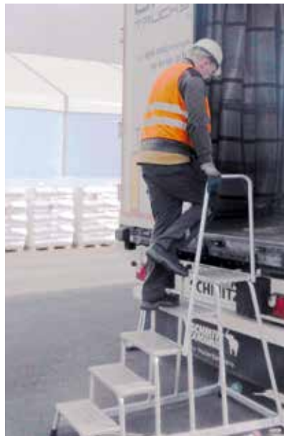
Abb. 2-23 / 2-24 Geländer, Haltegriffe, Laufstege, Stand- und Arbeitsflächen sowie abnehmbare Absturzsicherungen müssen genutzt werden.
