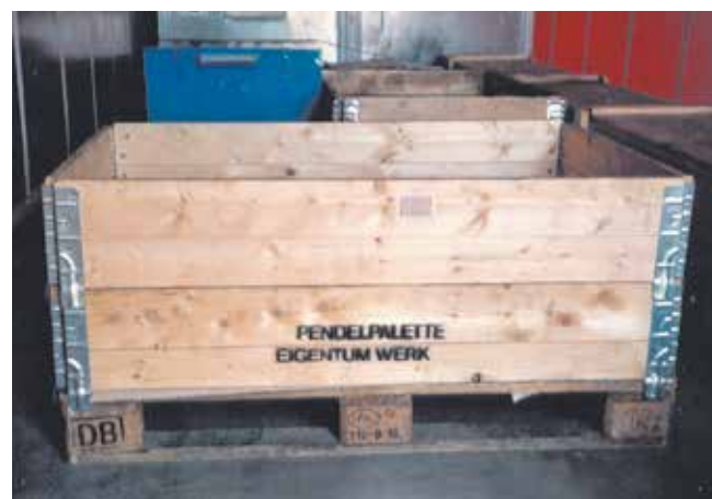
Abb. 4-10 Palettenaufsätze können Ladegüter auf der Palette formschlüssig sichern. Manche Palettenaufsätze werden auf handelsübliche Europaletten aufgesteckt. Andere Palettenaufsätze werden mit den Paletten fest verbunden.
