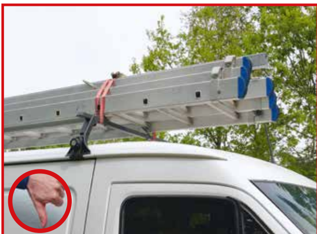
Abb. 10-22 Hier nicht geeignet zur Ladungssicherung: Niederzurren
