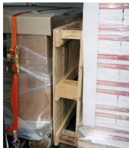
Abb. 7-13 Eine Leerpalette sichert die Ladelücke.
