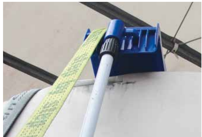
Abb. 6-18 Der Positionierer zum Auflegen von Kantenschutz dient dem Arbeitsschutz; das Auflegen der Kantenschützer ist vom Boden aus möglich; gefährliches Klettern entfällt.
