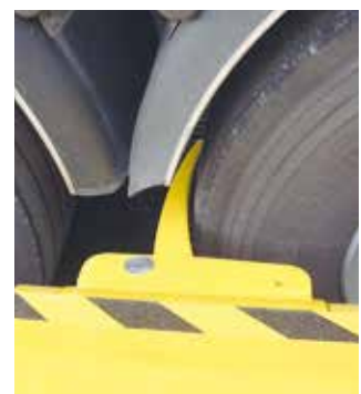
Abb. 2-16 Hat der Lkw die Beladestelle erreicht, schwenkt ein Blockierarm selbsttätig zwischen Rad und Schutzblech des Lkw und legt sich mit einer leichten Rückwärtsbewegung an diesen an.
