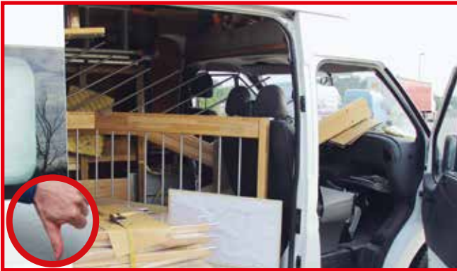
Abb. 10-8 Risikotransport für die Insassen; Transporter ohne Trennwand
