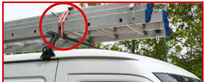
Abb. 5-6 Dachträger müssen fest mit dem Fahrzeug verbunden sein, so dass die im Fahrbetrieb auftretenden Massenkräfte aufgenommen werden können. Bei der Beladung des Dachträgers sind die Belastbarkeit des Trägers, die zGM, die Achslasten sowie die Belastbarkeit der Befestigungspunkte des Fahrzeugs zu beachten. Achtung: Auf den Gesamt-schwerpunkt achten. Anm.: Leitern sollten auf einem Dachträger direkt an der Strebe festgezurt werden. Das auf dem Foto gezeigte Niederzurren ist keine geeignete Art der Ladungssicherung!
