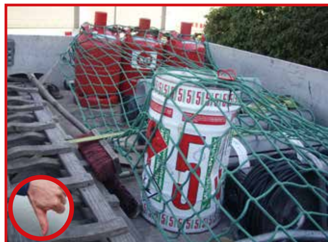
Abb. 10-24 Oft falsch angewendet: Abdecknetz
