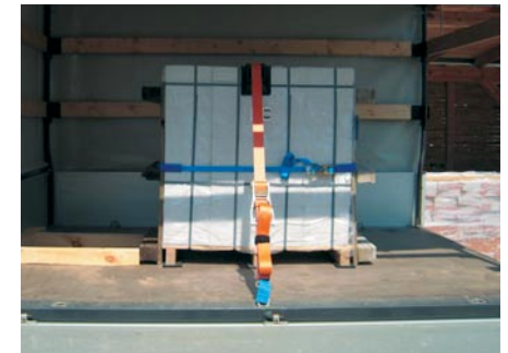
Bild 9: Verstellen der Ladung, da z. B. der Lastverteilungsplan eine Abstützung direkt an der Stirnwand nicht zulässt.
