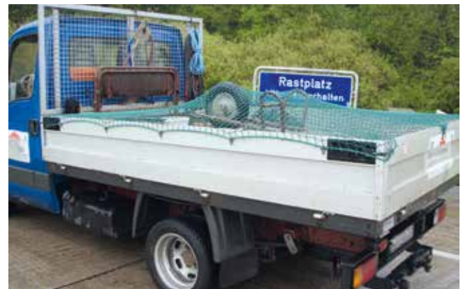
Abb. 10-13 Abdecknetz schützt andere Verkehrsteilnehmer
