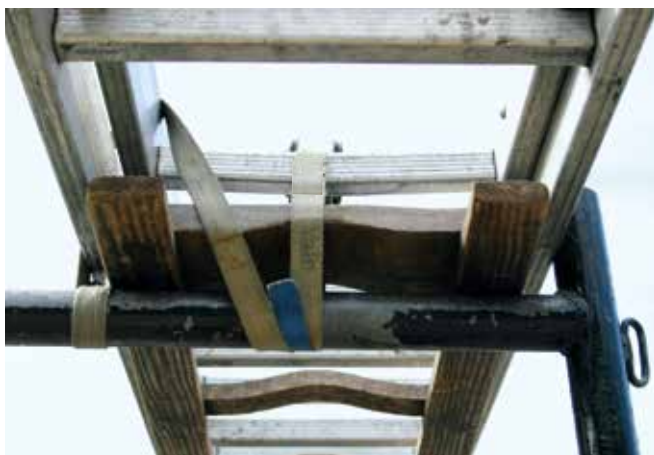
Abb. 10-21 Leitern auf Dachträger direkt an der Strebe festzurren
