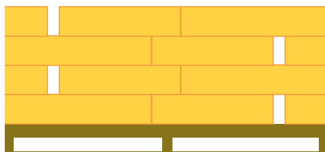
Abb. 4-12 Kleine Lücken versetzt anordnen
