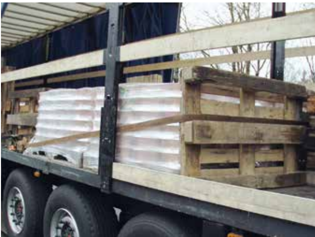
Abb. 7-37 Umreifungszurren, Sicht von oben
