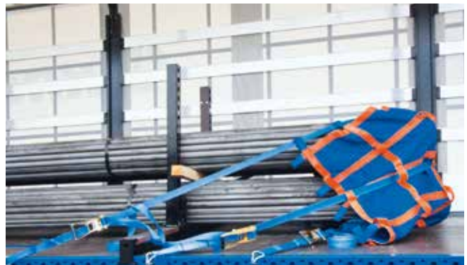
Abb. 6-43 Beispiel für die Sicherung von Langgut aus Stahl. Variabel nutzbare Einsteckungen sichern das Langgut seitlich. Die Sicherung nach hinten erfolgt durch eine hoch belastbare Gurt-/Planenkonstruktion.
