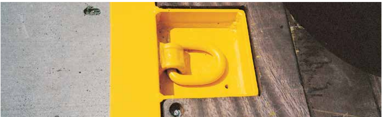
Abb. 5-25 Zurpunkte gemäß DIN EN 12640: Befestigungsvorrichtungen am Fahrzeug, an denen ein Zurmittel direkt befestigt werden kann
