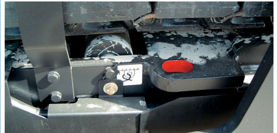
Bild 18: Kennzeichnung eines Zurrpunktes an einem Fertiger
