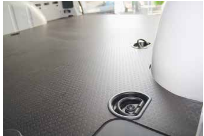
Abb. 5-8 Detailaufnahme eines im Boden eingelassenen Zurpunkts
