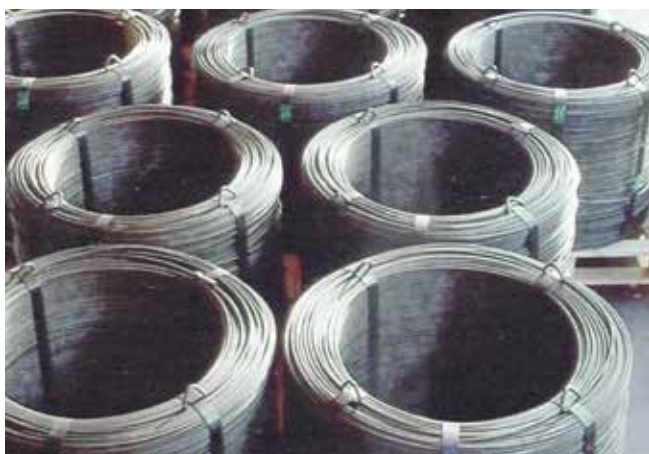
Abb. 10-84 Palettiert mit senkrechter Wickelachse; muss noch gegurtet werden!
