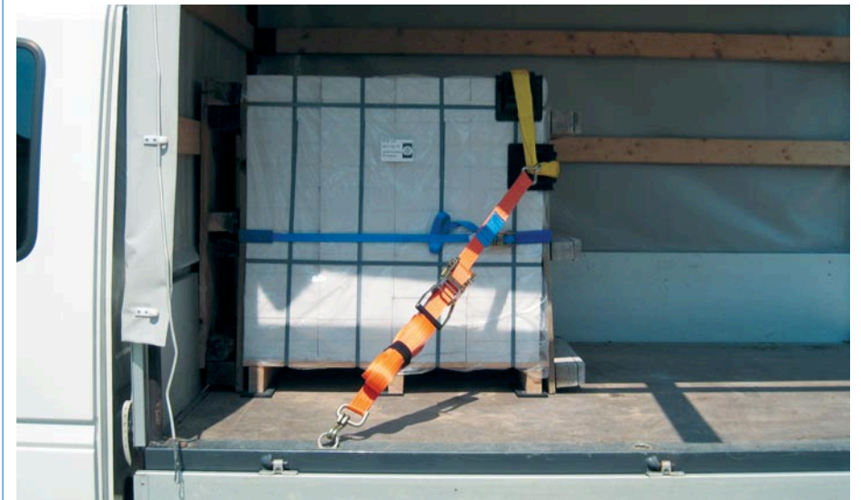
Bild 61: Steinpaket mit einem Zurrgurt und rutschhemmendem Material gesichert, gegen Verdrehen durch Blockierung an der Stirnwand gesichert
