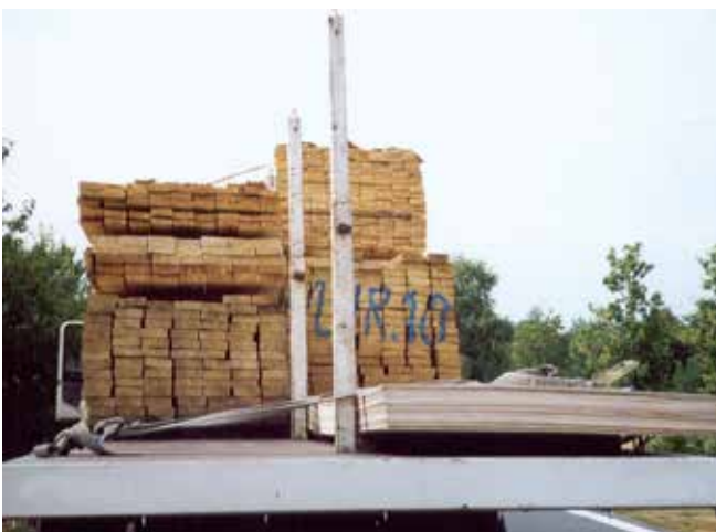
Abb. 10-40 Mittelrunge als Kippsicherung
