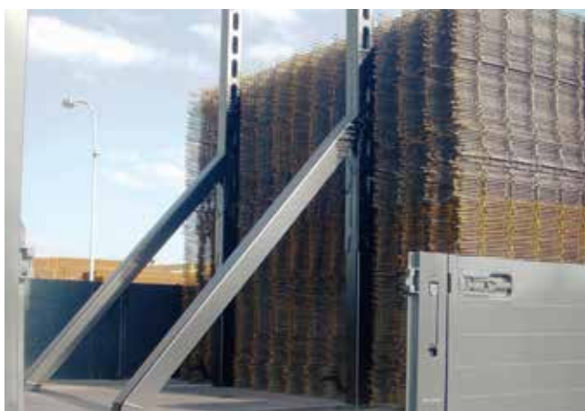
Abb. 10-77 Formschluss durch Steckungen
