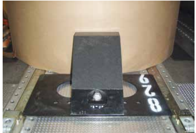
Abb. 6-53 Lochschiene mit Keilen
