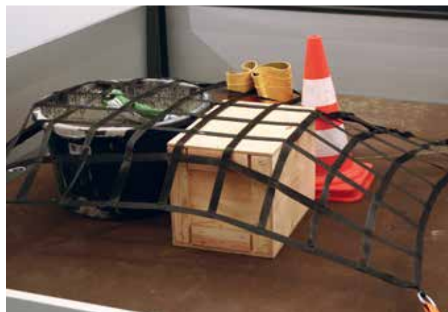
Abb. 10-23 Sehr gut einsetzbar: Zurrnetz
