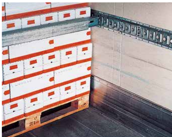
Abb. 6-60 Beispiel: Ankerschienen dienen der Aufnahme von Sperrbalken.
