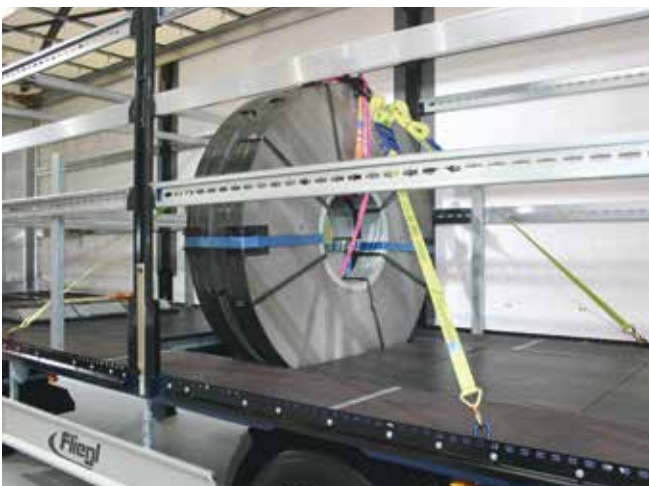
Abb. 10-61 Spaltband mit zusätzlicher Sicherung gegen Kippen
