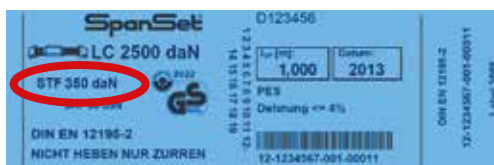
Abb. 8-36 Zurrgurtticket eines Zurrgurts mit einer S_{TF} von 350 daN
