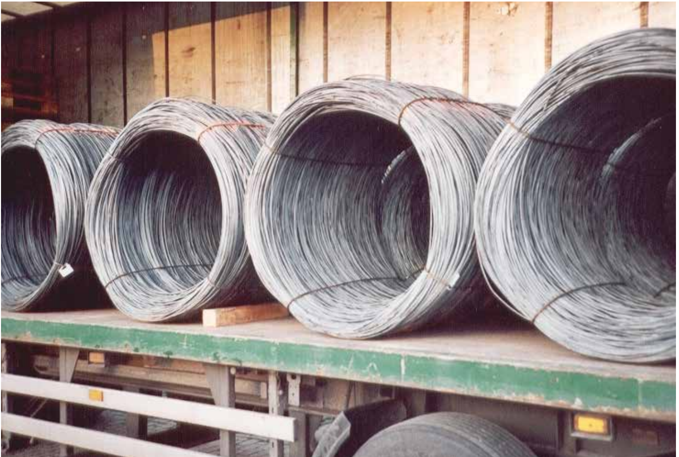
Abb. 10-81 Formschluss. Hinweis: Muss noch gegurtet werden!
