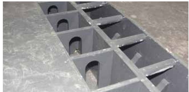
Abb. 5-29 Rungentaschenreihe mit Zurrloch; Belastung Zurrlöcher 2.000 daN
