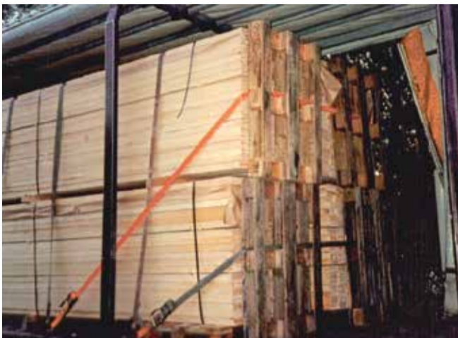
Abb. 10-29 Kopfschlinge mit Zurrgurten
