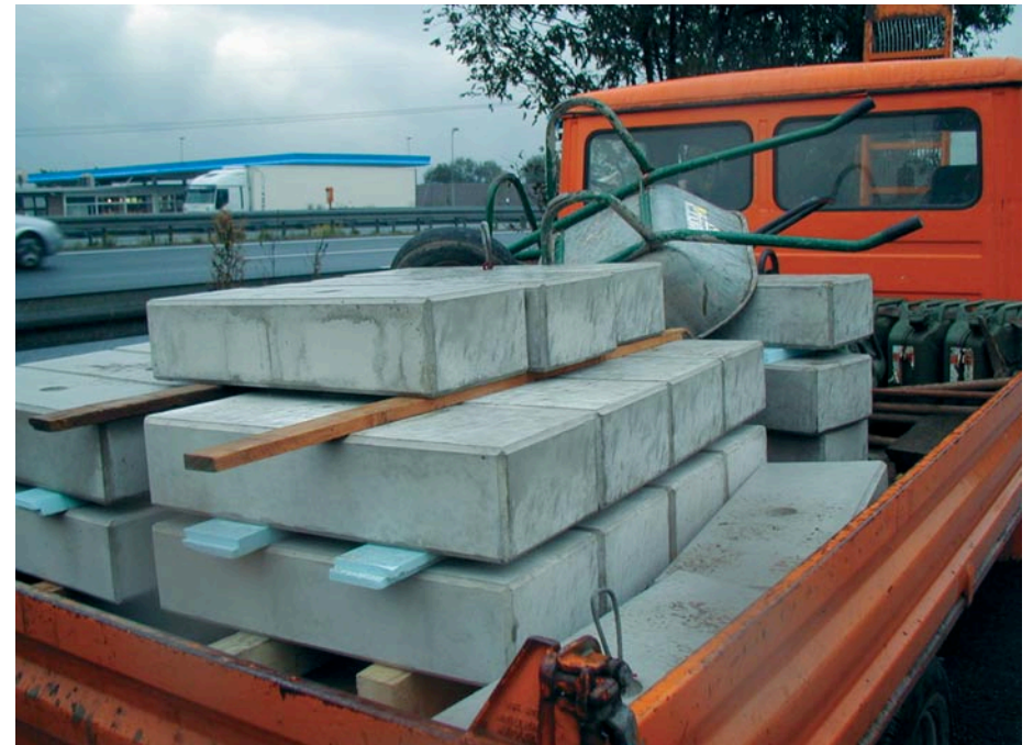
Bild 20: Nicht zulässiger Transport von Betonfertigteilen ohne Ladungssicherung
