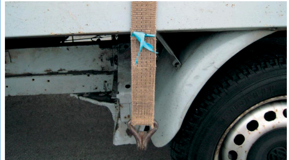
Bild 27: Fehlende Kennzeichnung am Zurrgurt
