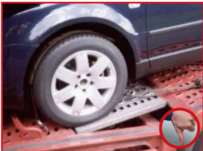
Abb. 10-106 Falsche Position: Radvorleger kann Rad nicht blockieren
