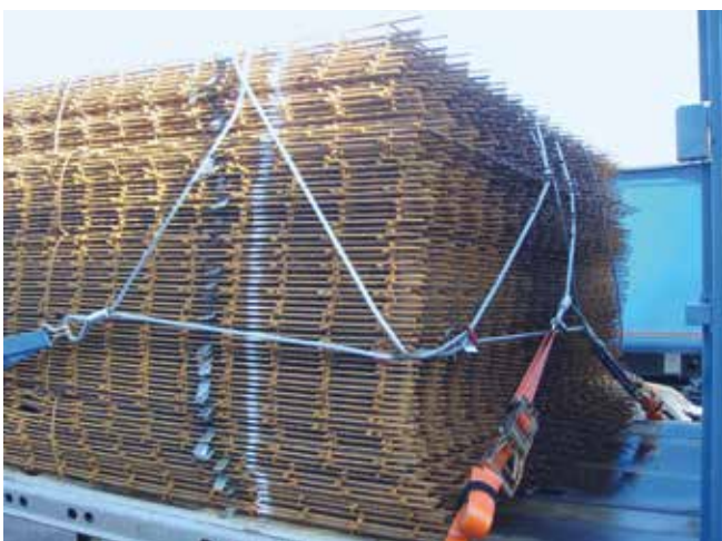
Abb. 10-75 Direktzurren mit speziellem Drahtseilsystem
