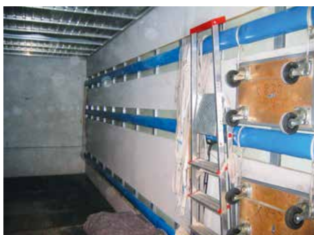
Abb. 10-52 Werkzeug und Hilfsmittel ebenfalls sichern
