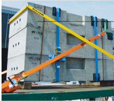
Bild 36: „Hilfszurrpunkte“ mittels Zurrecken links, sowie Kopflashing rechts
