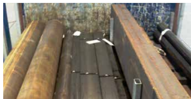
Abb. 10-92 Formschluss in Fahrtrichtung
