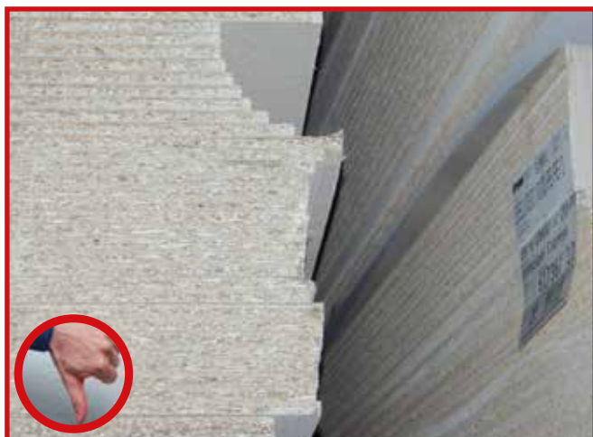
Abb. 10-36 Ladeinheit ist nicht transportsicher
