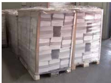
Abb. 4-14 Lücken im Verbund ausfüllen
