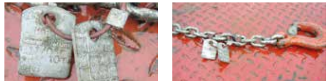
Abb. 6-24 / 6-25 Diese Ketten haben einen zweiten Anhänger mit Prüfdatum
