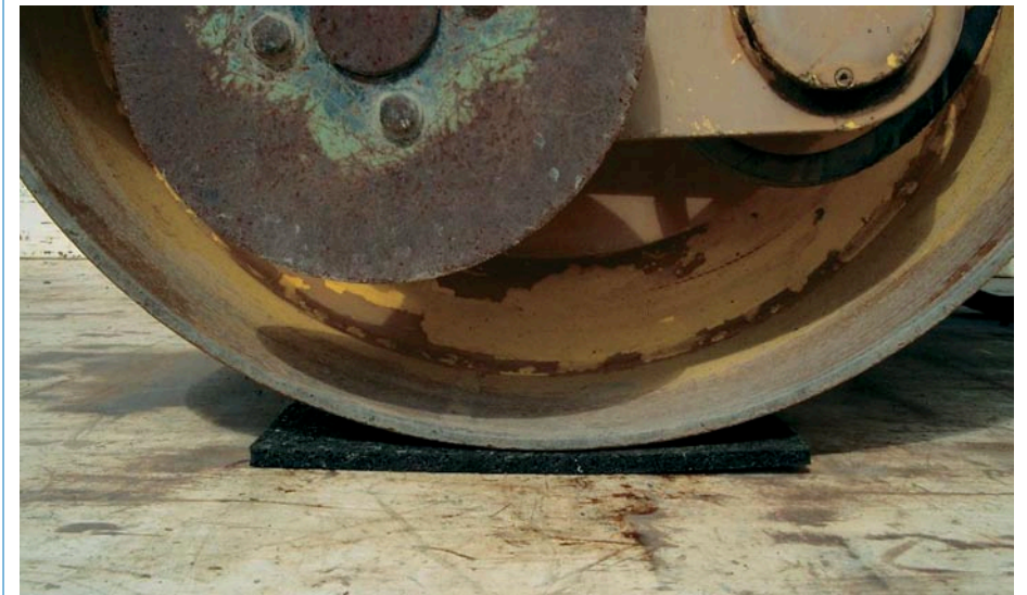
Bild 6: Einsatz einer Anti-Rutschmatte unter einer Walze
