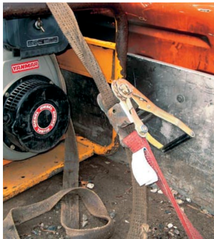
Bild 24: Nicht arretierte Zurrgurt-Ratsche
