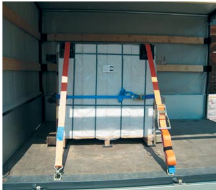
Bild 54: im Niederzurren mittels zweier Gurte und RHM gesichert
