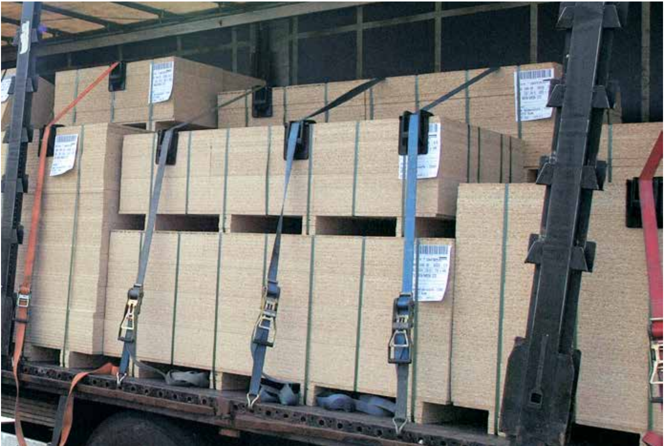
Abb. 10-32 Transportsichere Ladeeinheiten erleichtern die Ladungssicherung.
