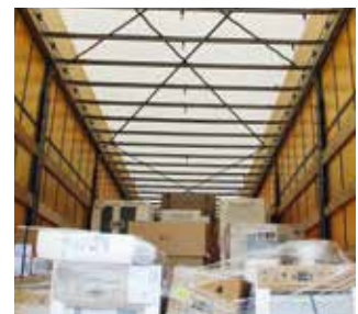
Abb. 5-15 Code XL-Fahrzeugaufbau (Dachverstrebungen zur Aussteifung)
