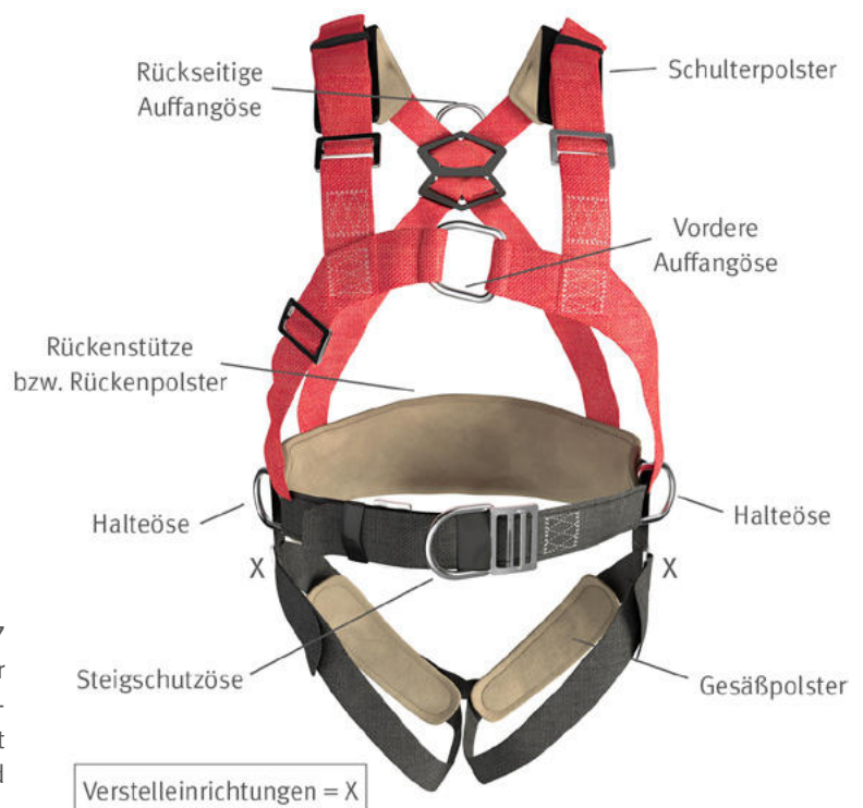
Abb. 27 Beispiel eines Auffanggurtes mit vorderer und rückseitiger Auffangöse, seitlichen Halteösen und einer Steigschutzöse. Der Gurt ist zusätzlich mit Schulter-, Beingurt- und Rückenpolstern ausgestattet.
