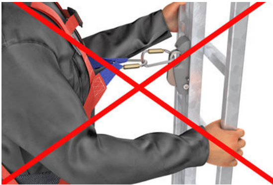
Abb. 77 Unzulässige Verlängerung der Zwischenverbindung mit einem Karabinerhaken
