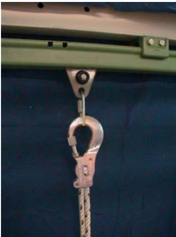
Abb. 17 Anschlageneinrichtung mit horizontaler Führungsschiene und beweglichem Anschlagpunkt
