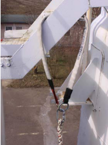
Abb. 14 Beispiele für Anschlagseinrichtungen der Klasse B – Bandschlinge, Trägerklemme
