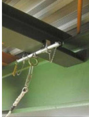
Abb. 14 Beispiele für Anschlagseinrichtungen der Klasse B – Bandschlinge, Trägerklemme
