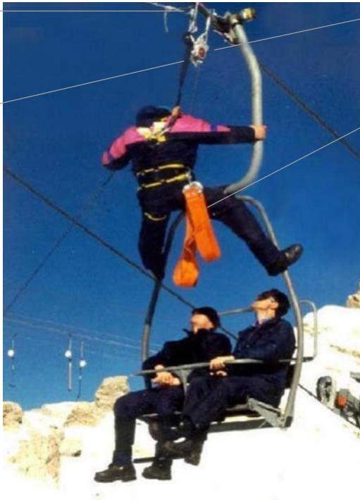
Abb. 24 Bergung aus einer Seilschwebbahn mittels Rettungsschleufe, Abseilgerät und Anschlaghilfe (Seilfahrgerät)
