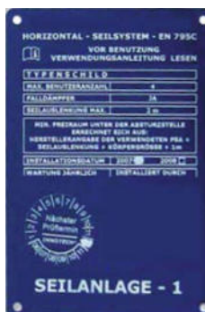
Beispiel für eine Anlagenkennzeichnung
