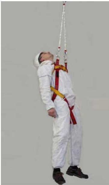
Abb. 1 Rettungsgurt mit zwei Rettungsösen im Brustgurtbereich
