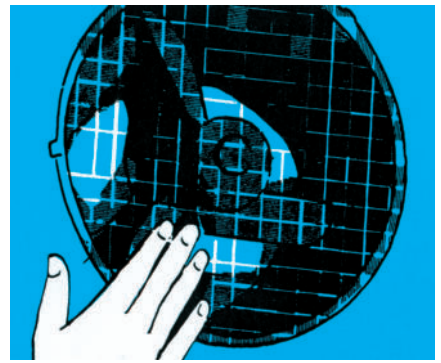
Bild 10-2: Mit Maschendraht gesicherter Ventilator
