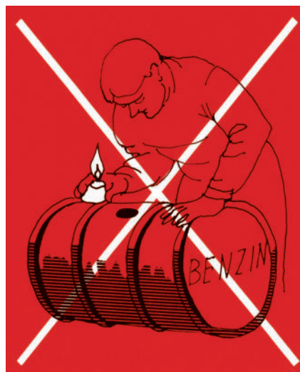
Bild 12-9: Ausleuchten von Behältern nur mit explosionsgeschützten Leuchten
