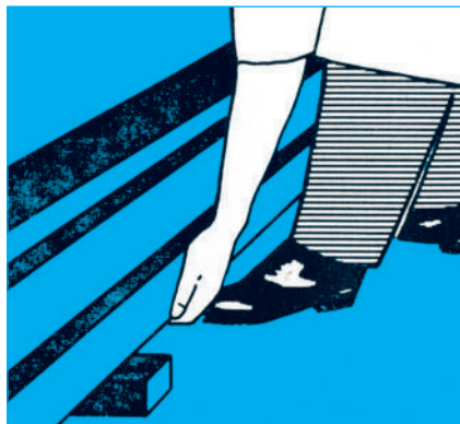
Bild 8-1: Zwischenlagen beim Stapeln von Balken
