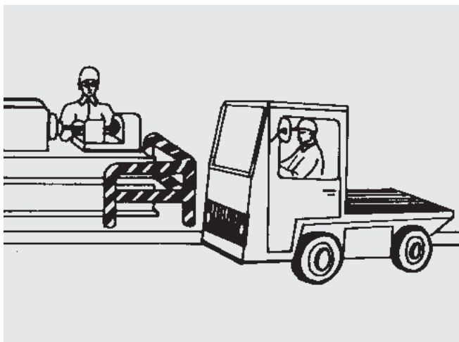
Bild 5-1: Anfahrschutz an Verkehrswegen
