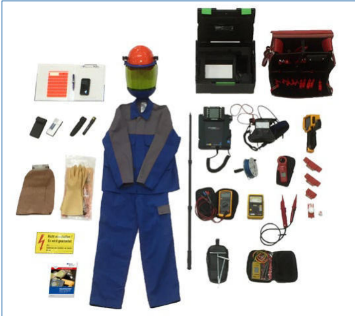
Abb. 3 Beispiel möglicher Ausstattung für die Prüfung elektrischer Anlagen und ortsfester Betriebsmittel
